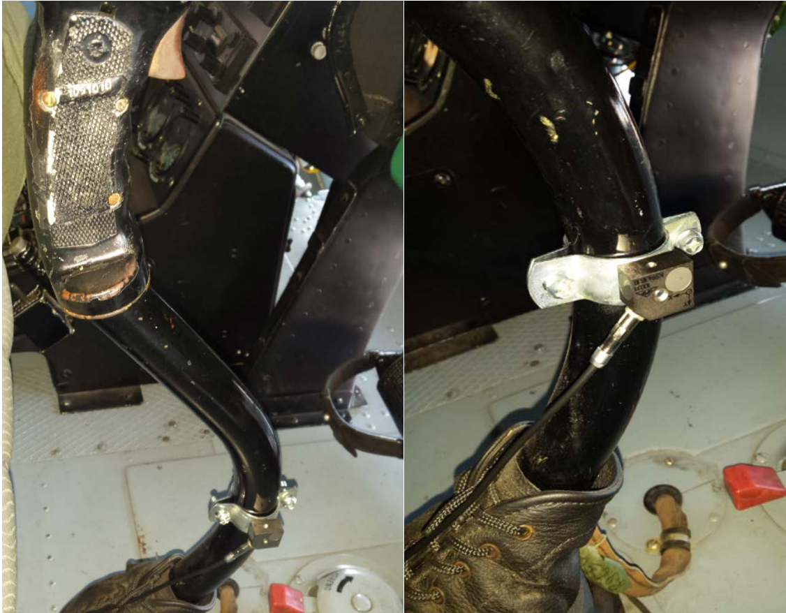
Slika 49. Troosni akcelerometar postavljeni na cikličnoj palici
