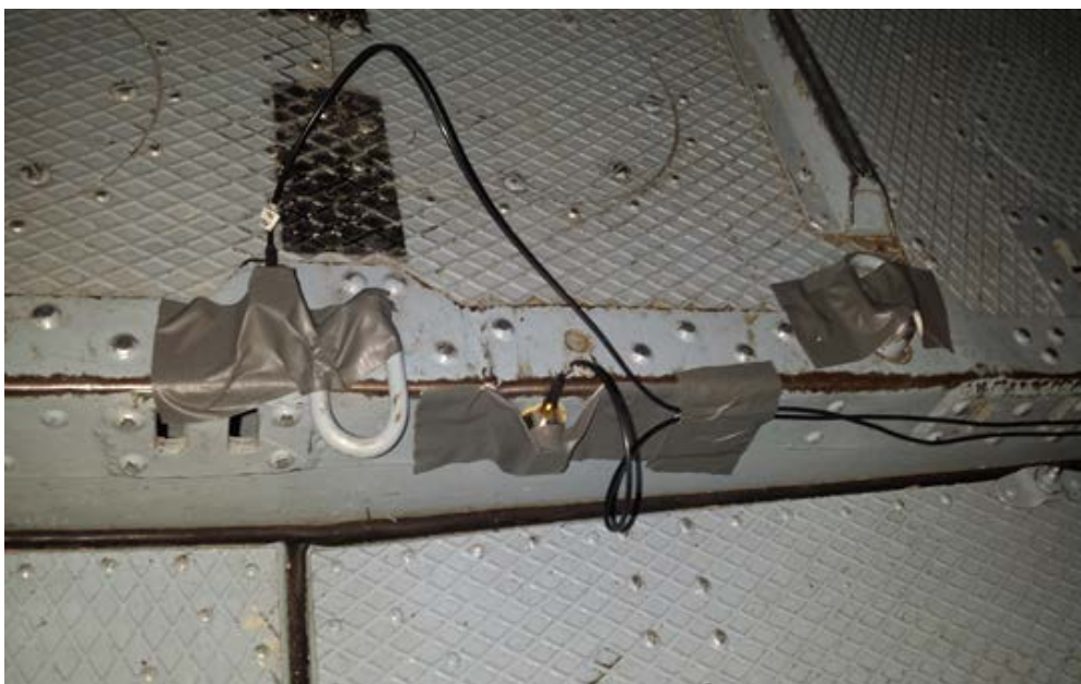
Slika 52. Dva jednoosna akcelerometra postavljena u teretnom prostoru
