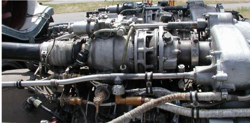
**Slika 15.** Zračni starter CB-78BA [17]
