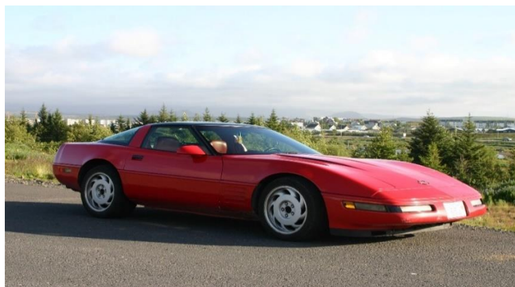
Slika 10. Klinasti oblik prednjeg dijela vozila [6]
