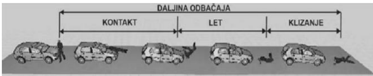
Slika 6. Faze frontalnog naleta [16]
