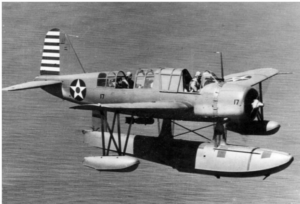
**Slika 3.** Hidrozrakoplov sa centralnim plovkom [5]
