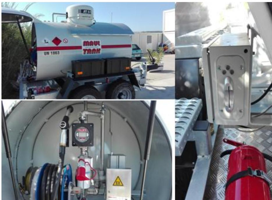
**Slika 22.** Cisterna za opskrbu hidrozrakoplova gorivom
