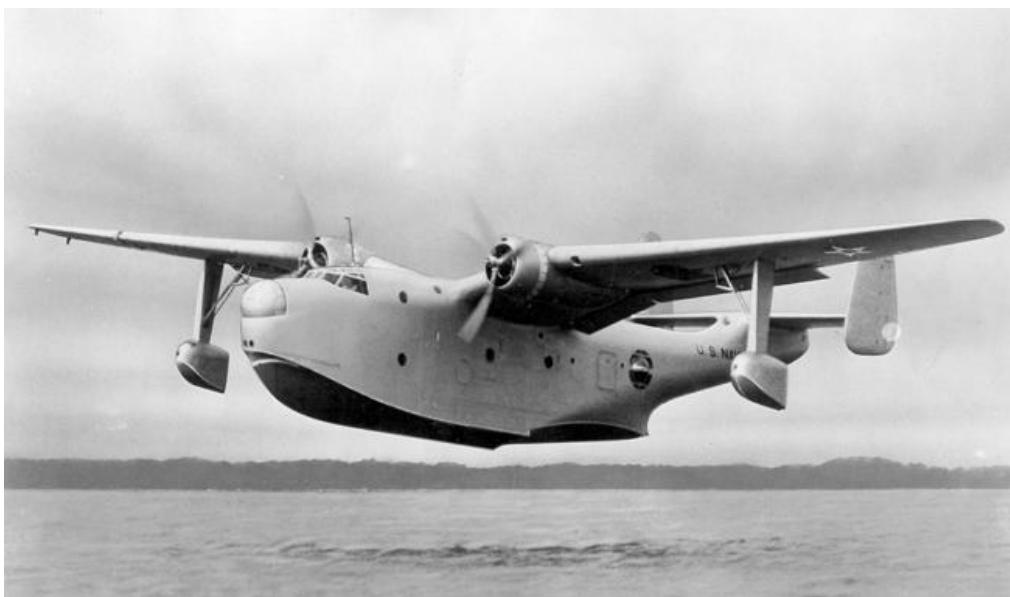
**Slika 4.** Hidrozrakoplov sa trupom kao centralnim plovkom [6]
