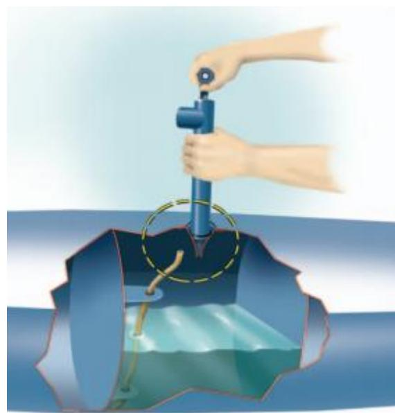
**Slika 7.** Pumpa za ispumpavanje plovka [7]
