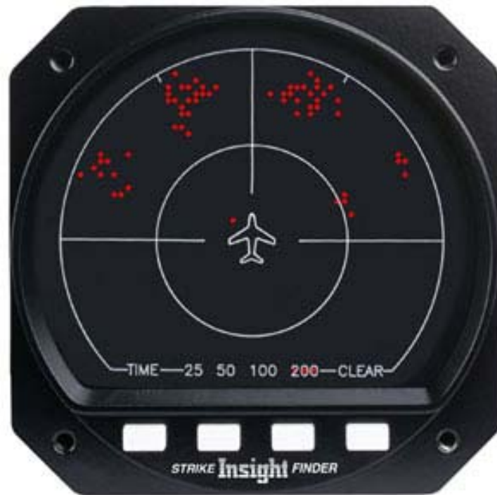
Slika 21. Prikaznik detektora elektrostatickog pražnjenja Strike Finder
