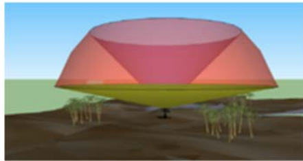
Slika 5. Volumen zraka pokriven radarom 4
