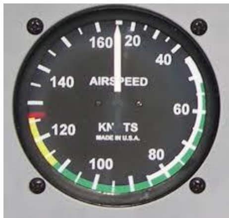
Slika 5. Prikaznik brzinomjera inducirane brzine [7]
