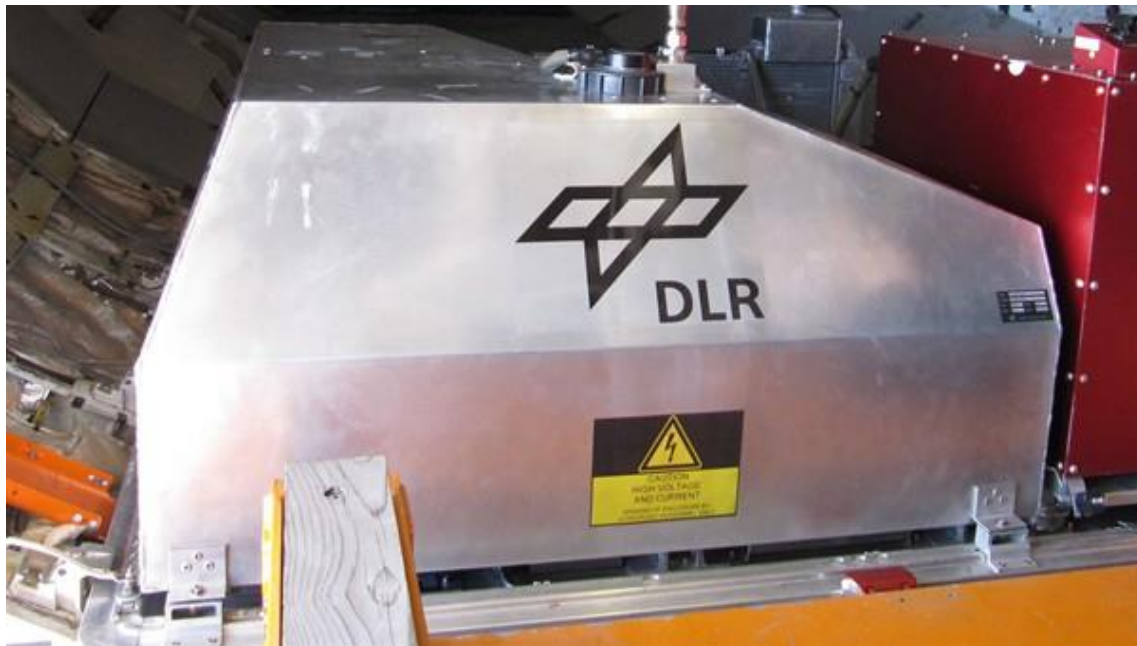
Slika 11: Smještaj gorivih ćelija u A320 DLR-a, Izvor:
