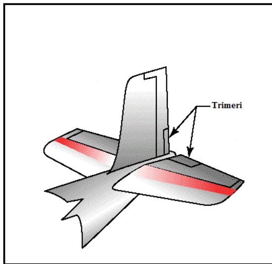
**Slika 6 - Prikaz trimera na repnim upravljačkim površinama**
