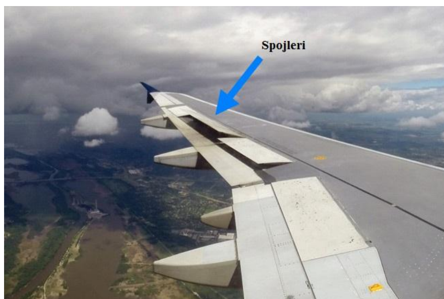
Slika 26 - Aktivirani spojleri na zrakoplovu A320
