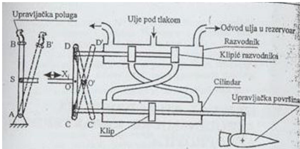
Slika 34 - Irreverzibilni hidraulički sustav upravljanja zrakoplovom [1]
