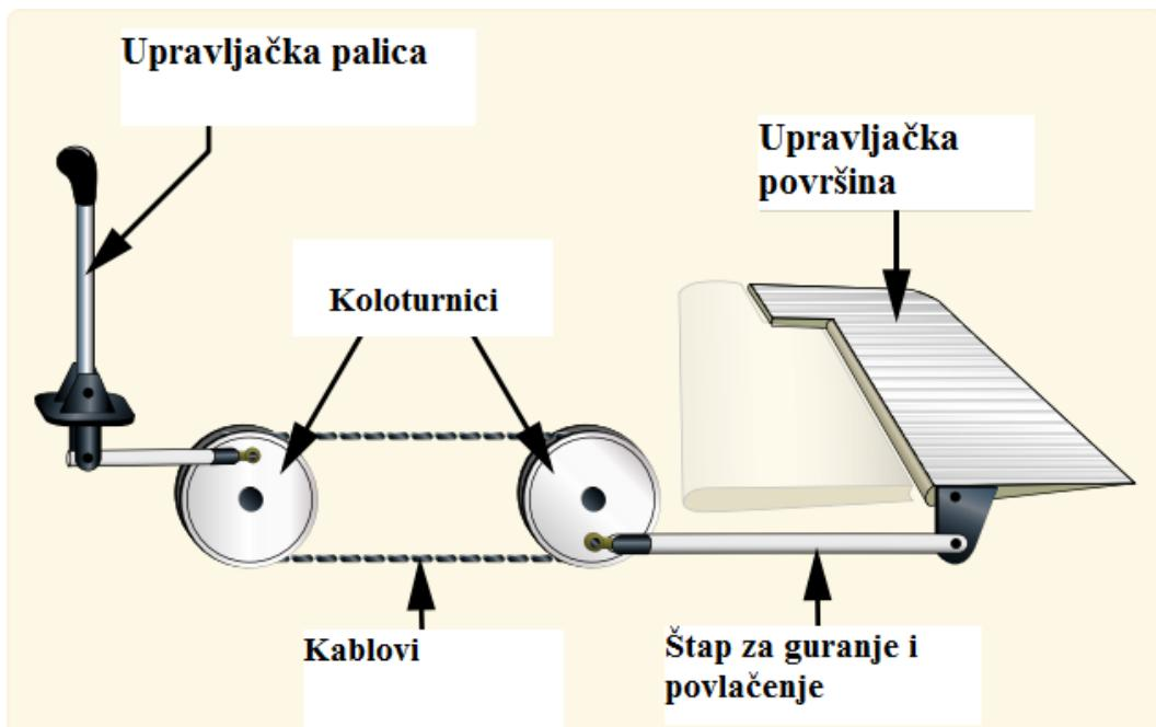
**Slika 30 - Mehanički sustav upravljanja zrakoplovom [3]**
