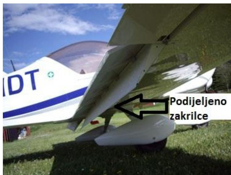
Slika 13 - Podijeljeno zakrilce na zrakoplovu Aero AT-3 [11]
