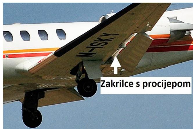
Slika 15 - Zakrilce s procijepom na zrakoplovu [12]
