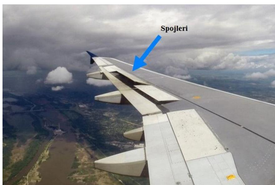
**Slika 26 - Aktivirani spojleri na zrakoplovu A320**
