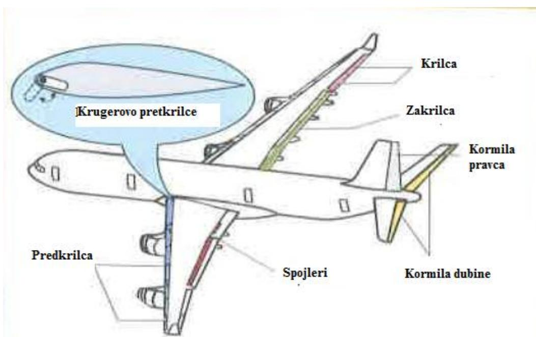
Slika 33 - Površine pogonjene hidrauličkim sustavom [2]
