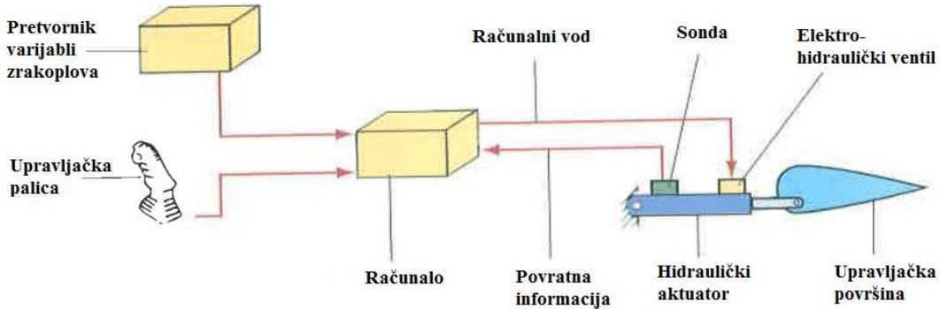
**Slika 35 - Shema sustava upravljanja zrakoplovom "Fly by Wire" [2]**
