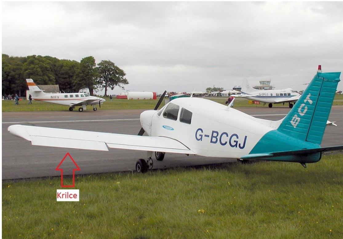
Slika 2 - Krilce otklonjeno prema dolje na zrakoplovu Piper Cherokee [16]
