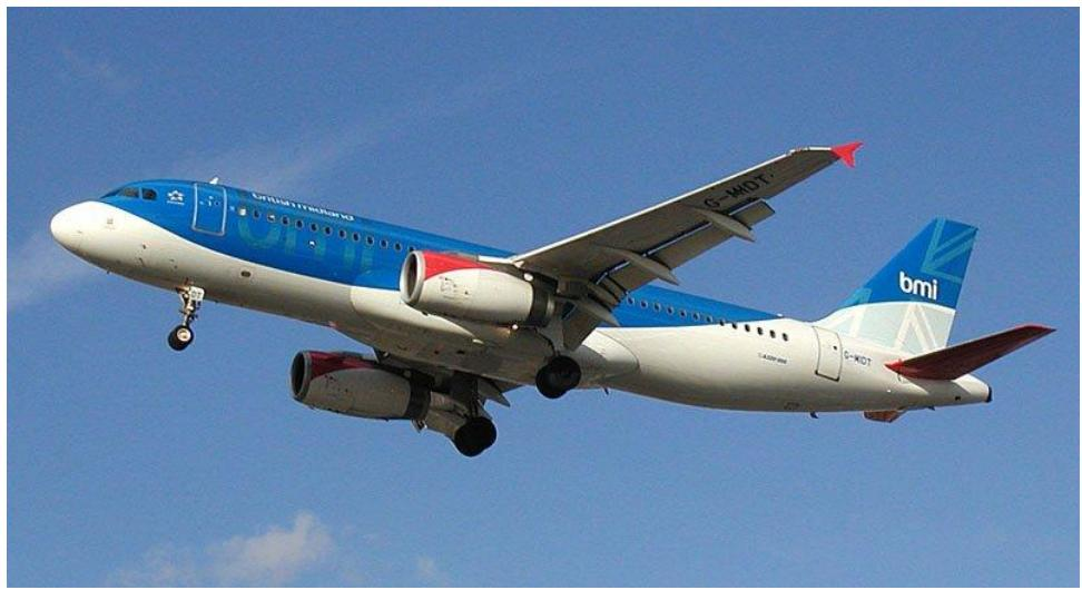
**Slika 36 - Airbus A320 - Prvi zrakoplov sa „Fly by Wire“ sustavom**
