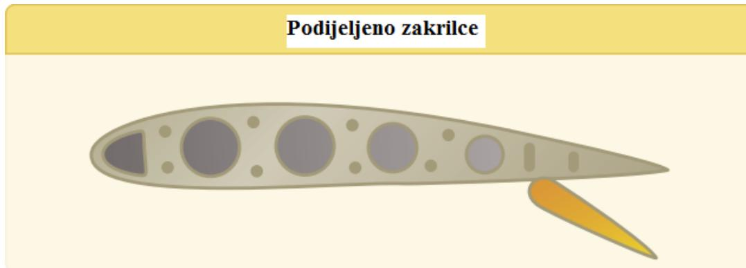
Slika 12 - Prikaz podijeljenog zakrilca [3]
