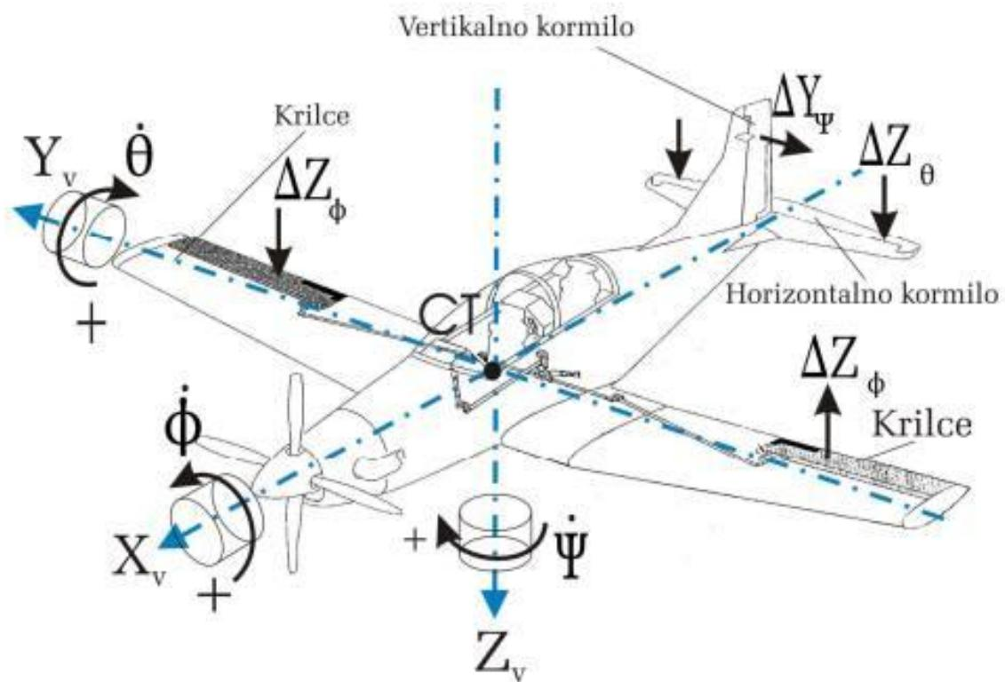
Slika 1 - Upravljačke površine zrakoplova sa pozitivnim smjerovima rotacija [1]
