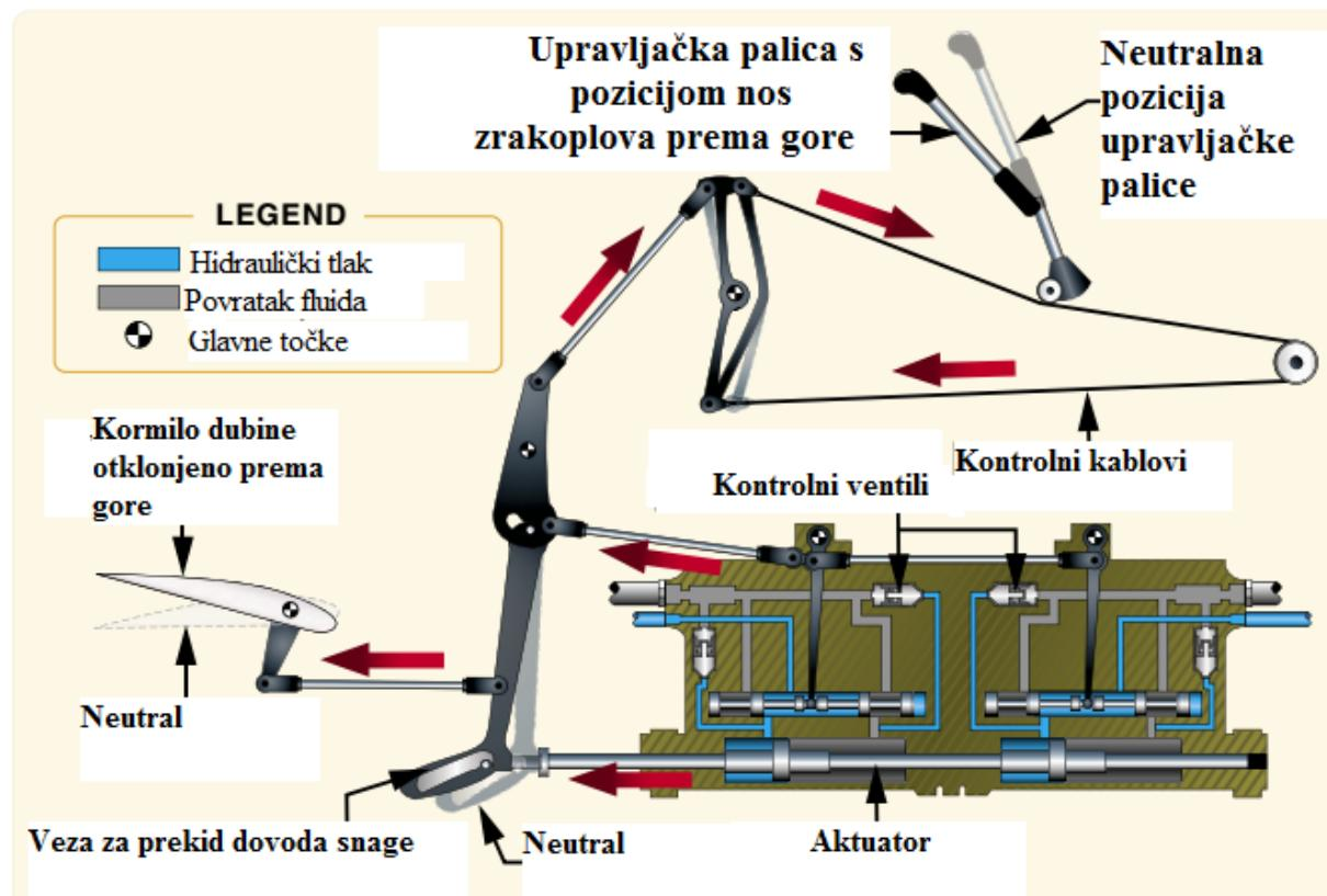
Slika 32 - Reverzibilni sustav upravljanja zrakoplovom [3]
