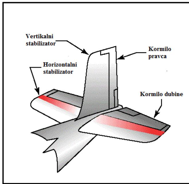
**Slika 4 - Prikaz vertikalnog stabilizatora i kormila pravca na repu zrakoplova te horizontalnog stabilizatora i kormila dubine**
