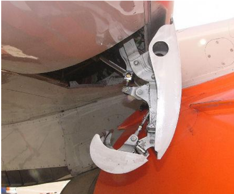
Slika 25 - Krugerovo pretkrilce na zrakoplovu Boeing 737
