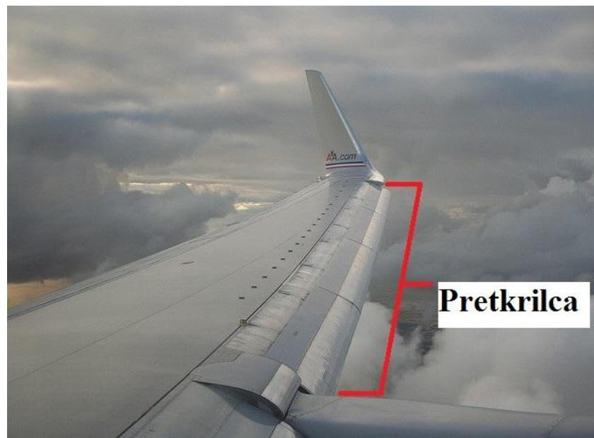
Slika 19 - Prekrilca na krilu zrakoplova
