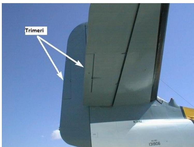
**Slika 7 -Trimeri na zrakoplovu Grumman HU-16A [9]**
