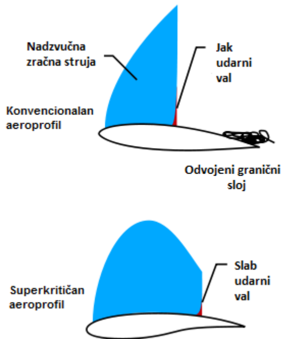
Slika 25: Konvencionalan i superkritičan aeroprofil [7]
