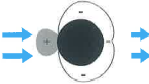
Slika 5: Tlak oko cilindra u uvjetima viskoznog fluida [1]
