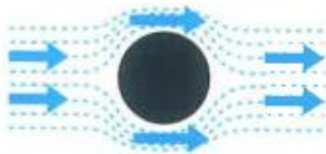
Slika 2: Protok fluida bez viskoznosti uzduž tijelo cilindra [1]
