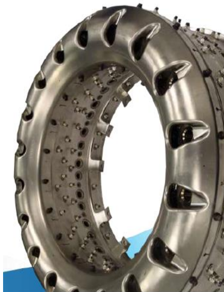
Slika 16: Prstenasti tip komore izgaranja TALON X, [26]
