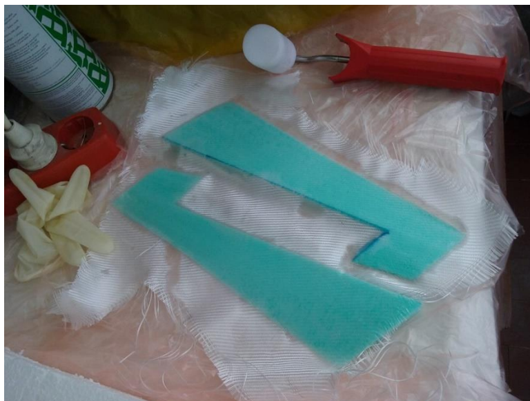
Slika 19. Postavljanje stakloplastike i epoksidne smole na kormila "V" površine
