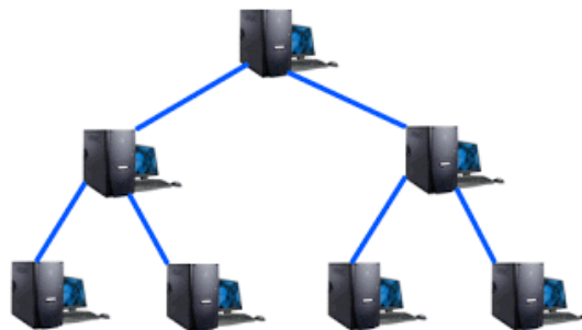
Slika 4 Prikaz stablaste topologije [7]
