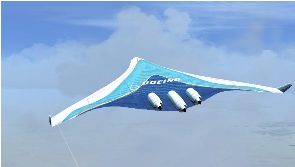
Slika 15. Primjer BWB koncepta na zrakoplovu Boeing 797 [21]
