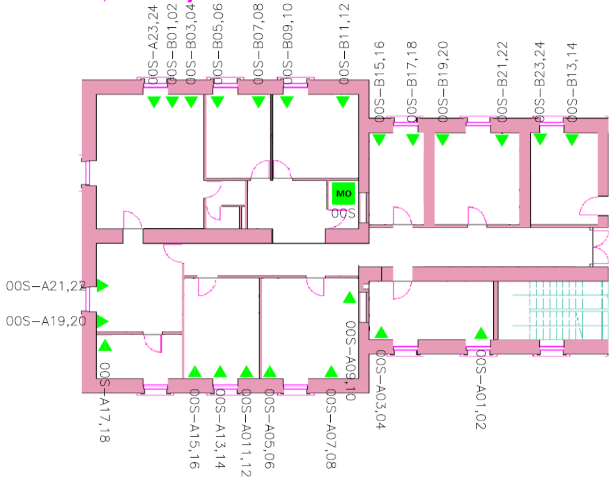
Slika 9. Lokacije mrežnih utičnica na prizemlju sjevernog krila
