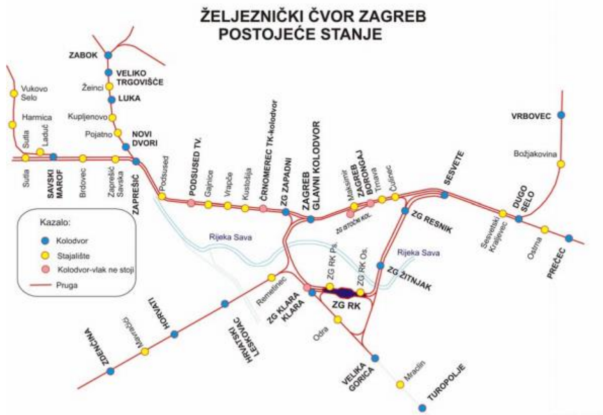
Slika 1. Postojeće stanje željezničkog čvora Zagreb
