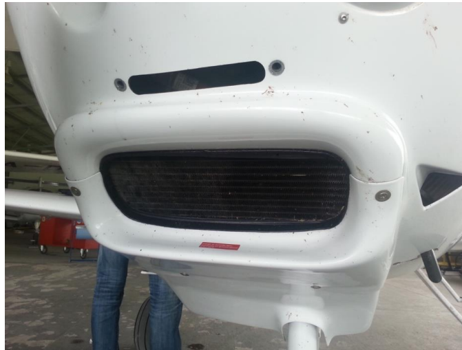
Slika 4: Pogled na pročistač usisnog sustava DV20
