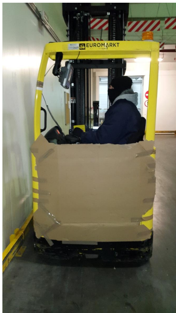
Slika 23: Improvizirana zaštita postavljena na visokoregalni viličar Izvor: Izradio autor
