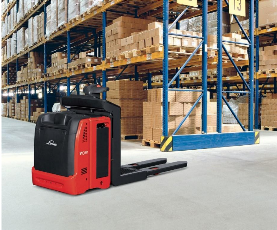
Slika 12: Ručni električni viličar predviđen za komisioniranje Izvor: www.linde.com , travanj 2016.
