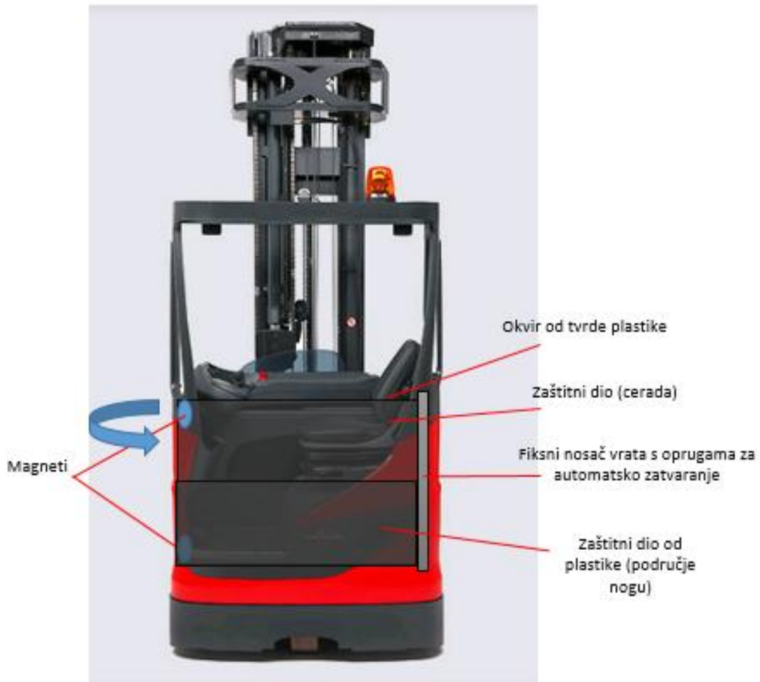
Slika 27: Djelomično zatvaranje otvorene strane viličara po principu poluautomatskih vrata
