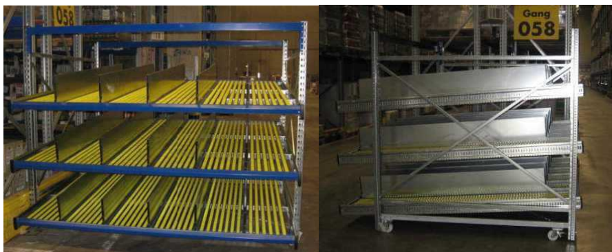
Slika 25.: Primjer mobilnog KDR regala u trgovačkoj tvrtki
