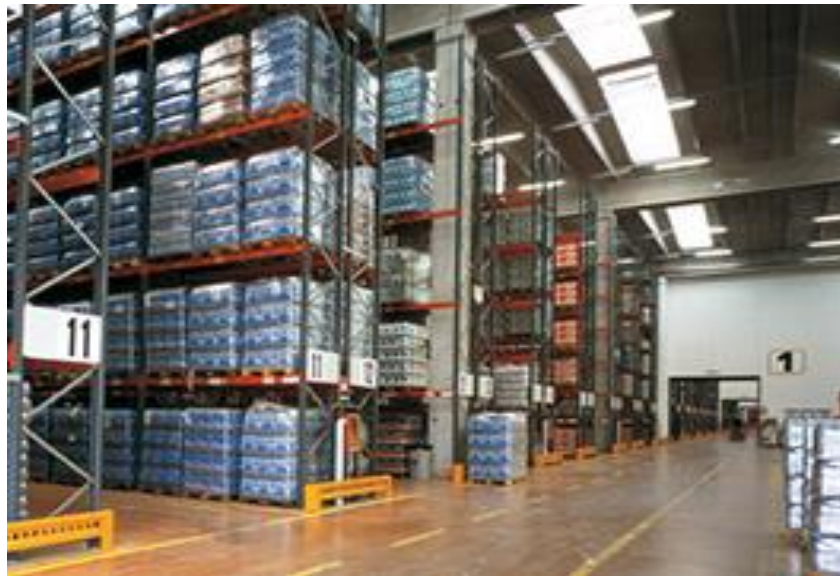
Slika 20.: Primjer jednostrukog paletnog regala
