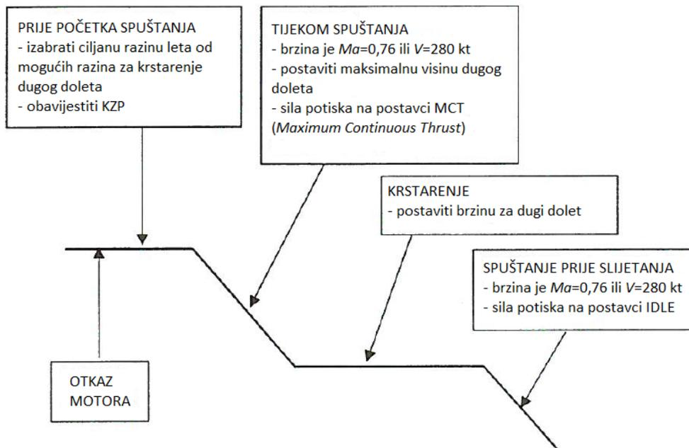
Slika 6.4. Standardna procedura nakon otkaza motora, izvor: [5]
