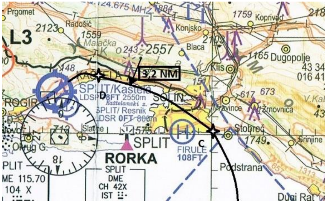
Slika 11. Prikaz udaljenosti između konstruirane crte zakrivljenog prilaza i planine
