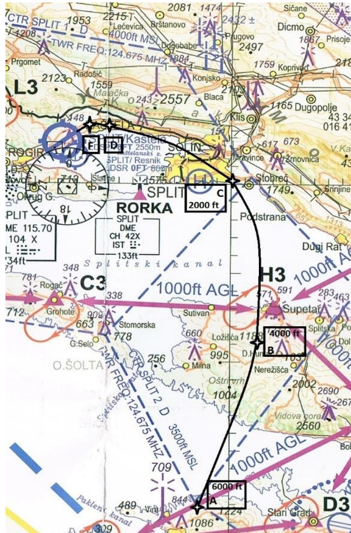
Slika 10. Prikaz moguće izvedbe zakrivljenog prilaza za stazu 23
