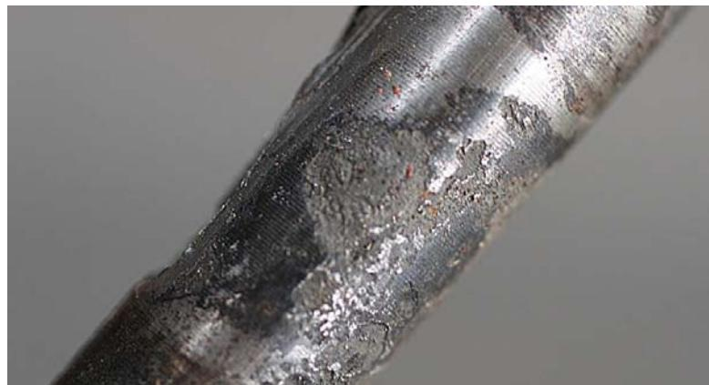
**Slika 3.** Kontaktna korozija [9]
