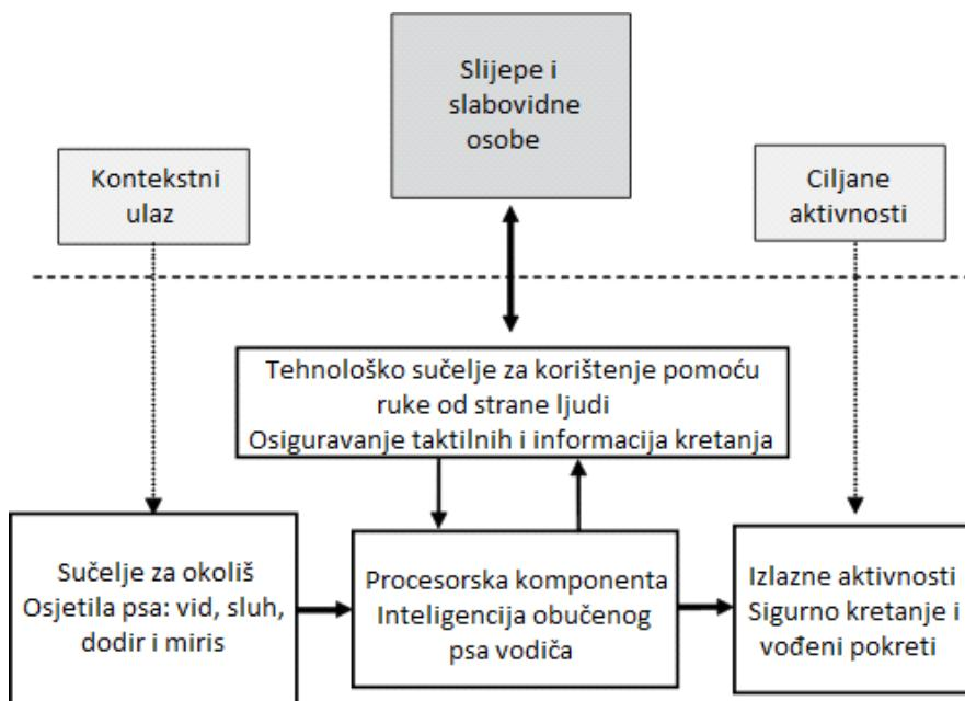
Slika 1. Blok dijagram robotskog vodiča za slijepе osobe, [7]
