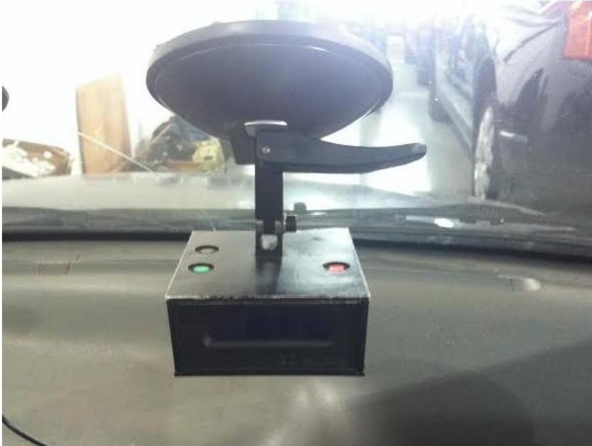
Slika 20. Prikaz postavljenog XL-metra na vjetrobransko staklo vozila, [19]
