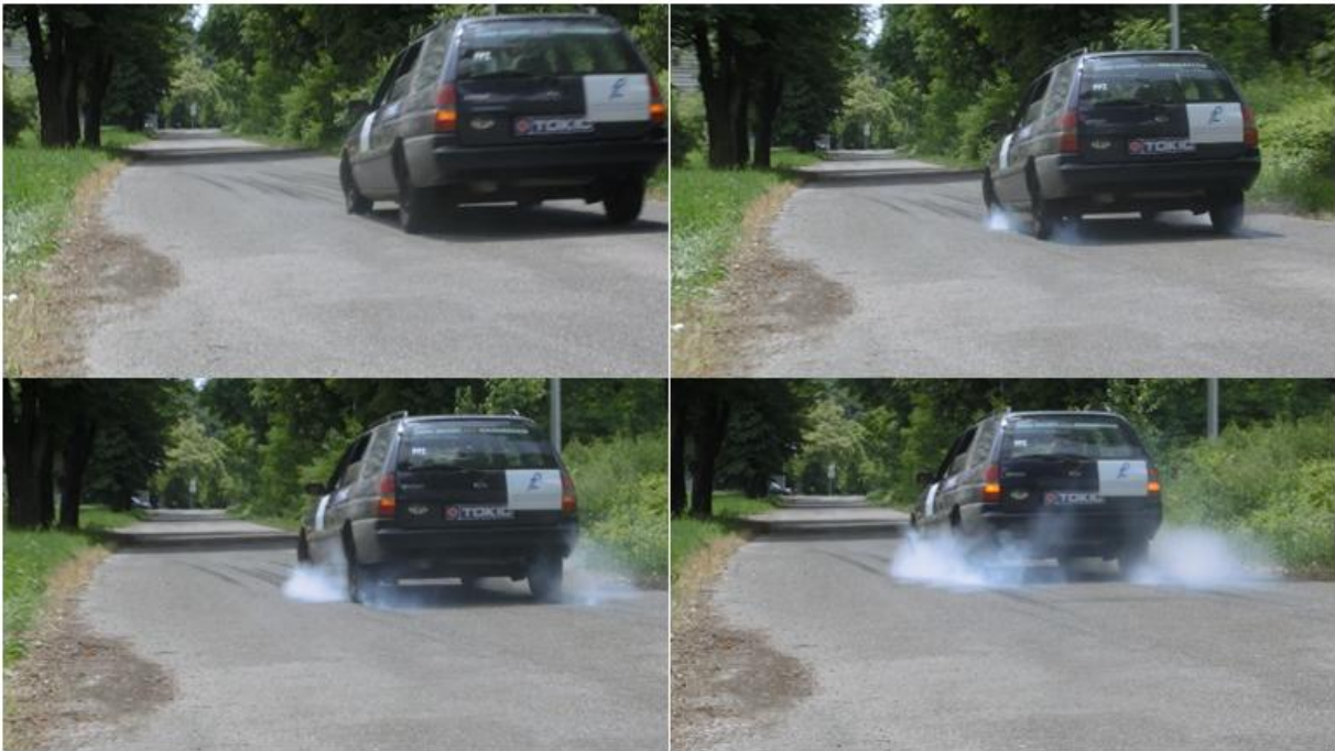
Slika 21. Prikaz nastanka dima prilikom intenzivnog kočenja sa brzinom 50km/h s isključenim ABS sustavom.
