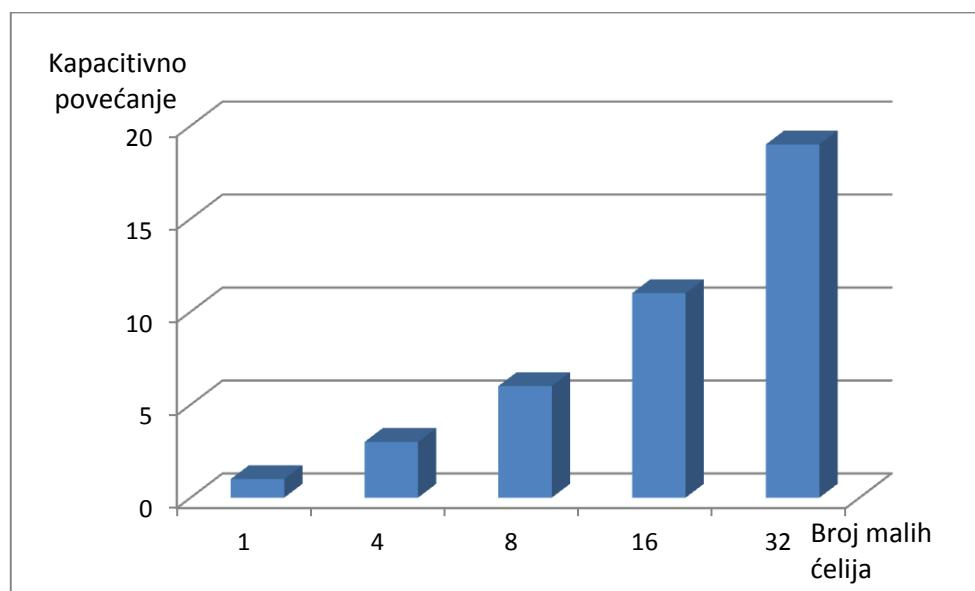
Slika 13: Rast kapaciteta mreže usporedno sa dodavanjem malih čelija
