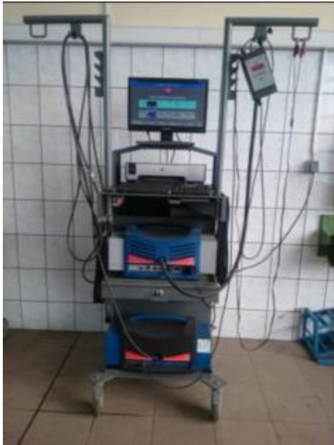
Slika 7. Prikaz dvaju različitih uređaja za analizu ispušnih plinova
