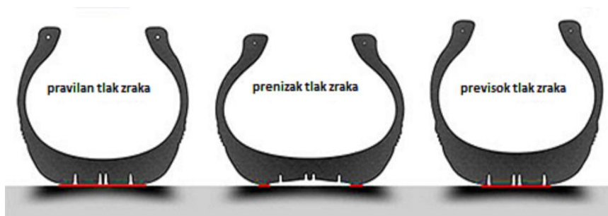
Slika 25. Prikaz pneumatika sa ispravnim tlakom zraka, preniskim i previsokim tlakom zraka od optimalnog [19]
