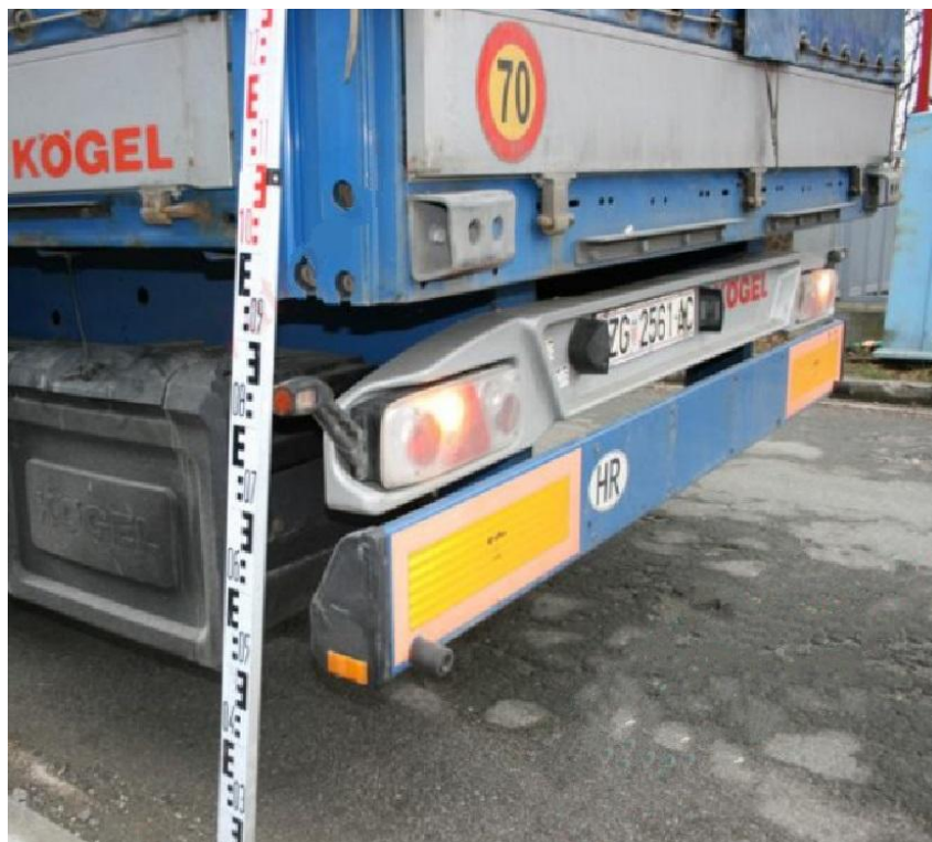
Slika 17. Mjerenje oštećenja na vozilu pri čemu mjerna letva nije pravilno postavljena, niti su oštećenja označena.
