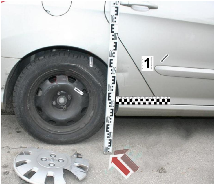
Slika 15. Mjerenje bočnih oštećenja na vozilu uz mjernu letvu i mjernu traku koje su međusobno okomito postavljene, a oštećenja označena strelicama
