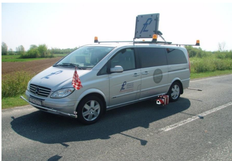
Slika 23. Mjerno vozilo sa montiranim uređajem ZDR 6020
