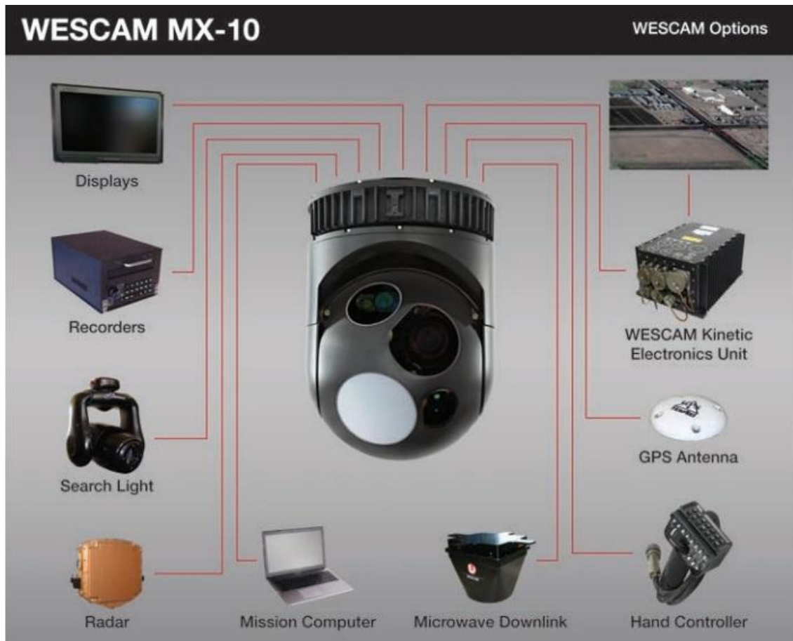
Slika 32. Način spajanja MX-10 [21]
