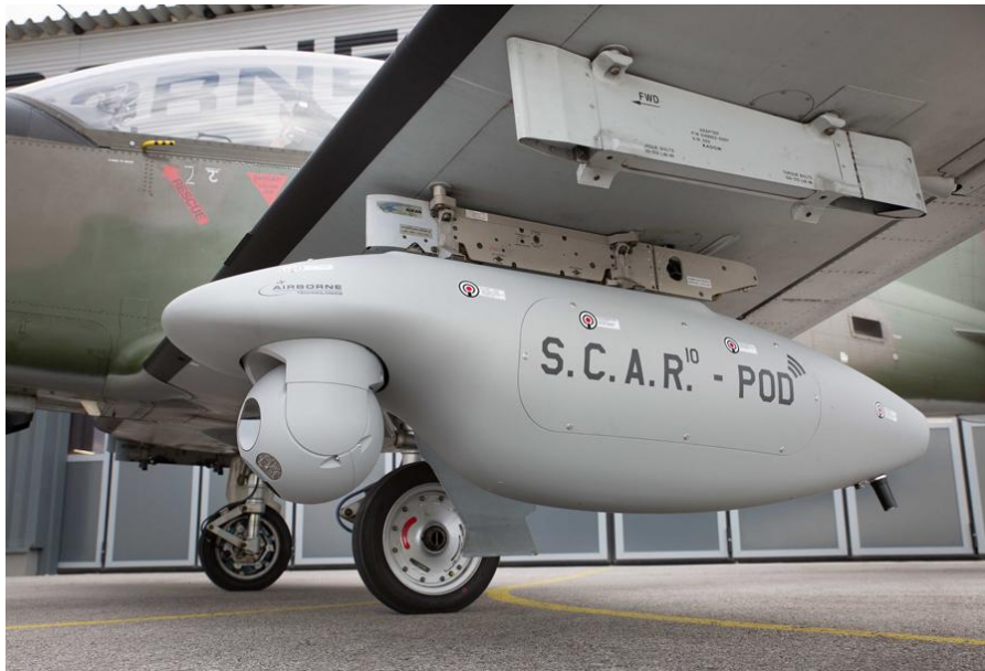
Slika 79. S.C.A.R. - POD podvjesni nosač kamere
