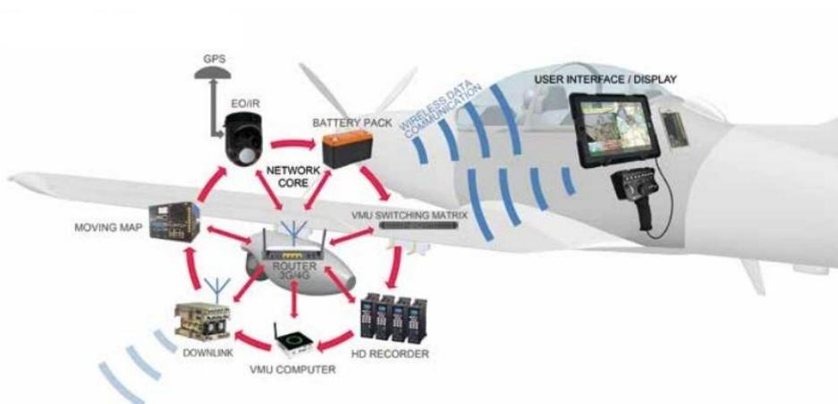
**Slika 80.** Način komunikacije S.C.A.R. – POD-a, njegovih elemenata s upravljačkom konzolom
