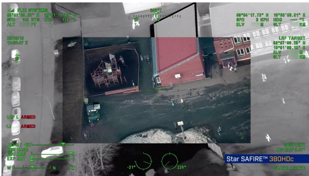
Slika 60. Preklapanje slike sa dva senzora
