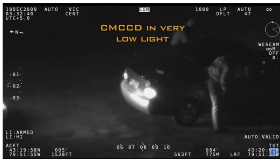
**Slika 46.** Snimanje pri slabom osvjetljenju sa CMCCD senzorom
