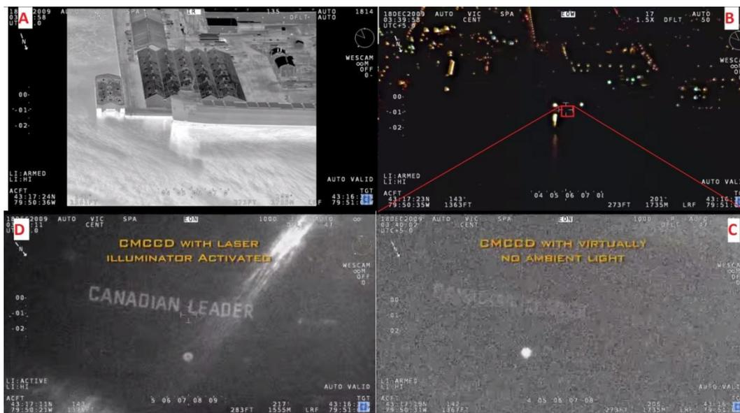
**Slika 47.** Prikaz mogućnosti laserskog osvjetlivača
