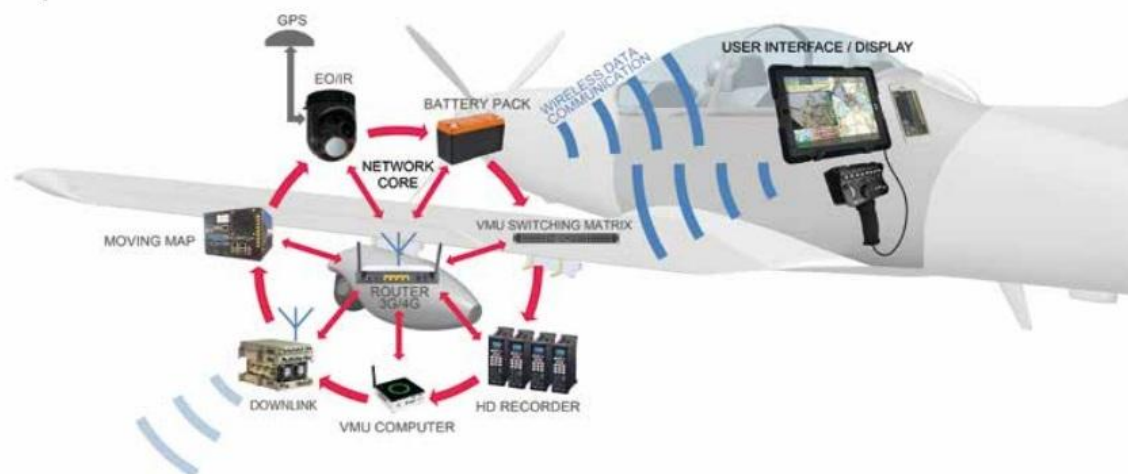
Slika 41. Prikaz spajanja S.C.A.R. - POD -a[24]
