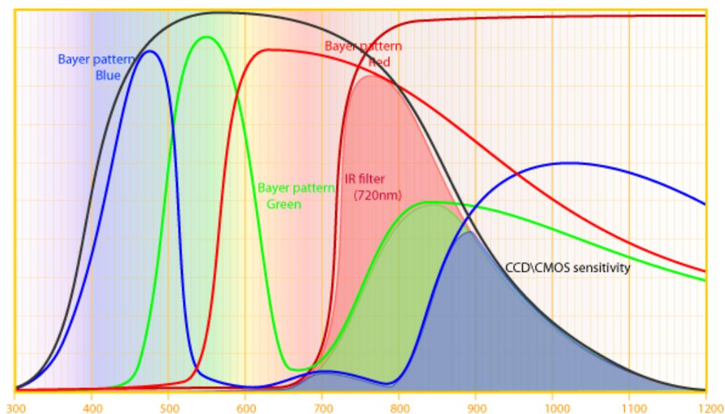
**Slika 4.** Prikaz blokiranja filtra od 720 nm [7]
