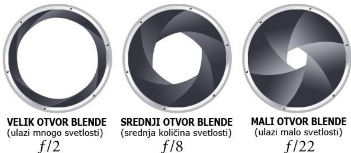
Slika 15. Primjer otvorenosti blende [17]
