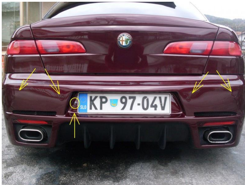
Slika 28. Smještaj senzora za pomoć pri parkiranju unatrag [37]
