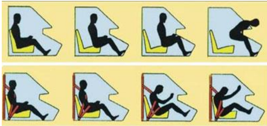
Slika 20. Kretanje nevezanog i vezanog tijela sigurnosnim pojasom [9]
