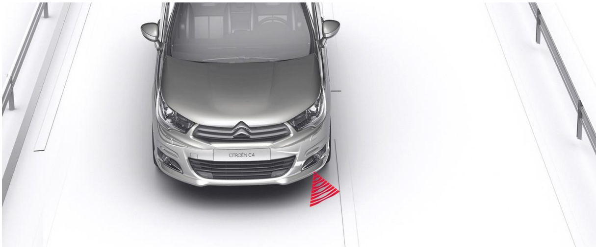
Slika 39. Sustav za upozorenje o nenamjernom prelaženju crte uz pomoć senzora [45]
