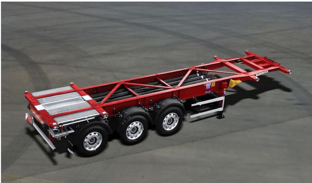
Slika 7. Poluprikolica za prijevoz kontejnera.
