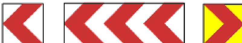
Slika 16. Ploče za označavanje zavoja na cesti (K12,K13 i K14), izvor [6]
