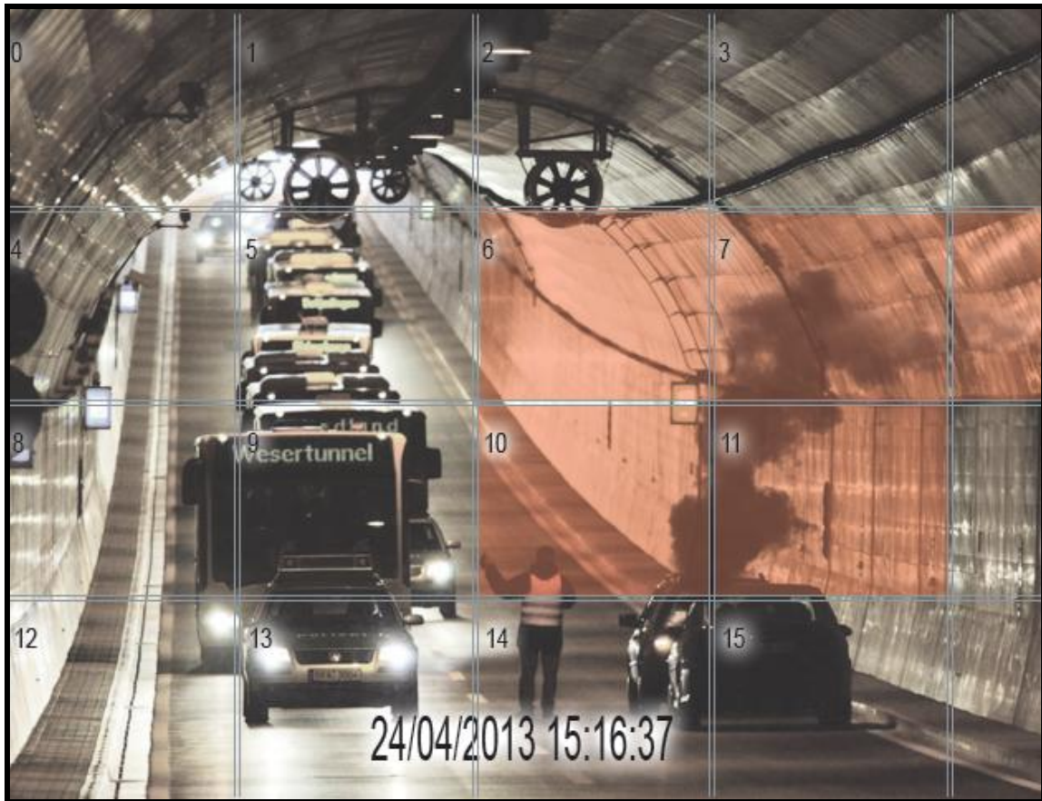
Slika 32. Video detekcija dima (podjela vidnog polja po zonama), izvor [31]
