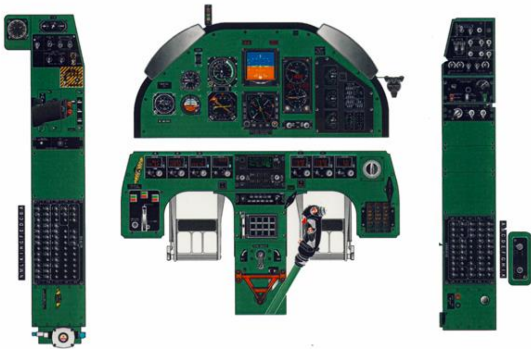
Slika 4. Prednja kabina aviona PC9-M, [4]
