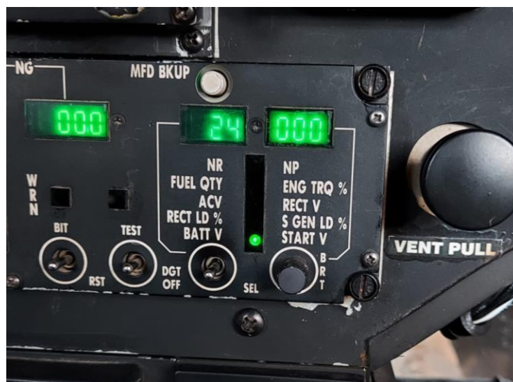
Slika 24. Prikaz napona akumulatora u pilotskoj kabini
