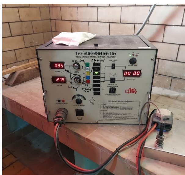
Slika 13. Uređaj za testiranje nikal-kadmijevih akumulatora
