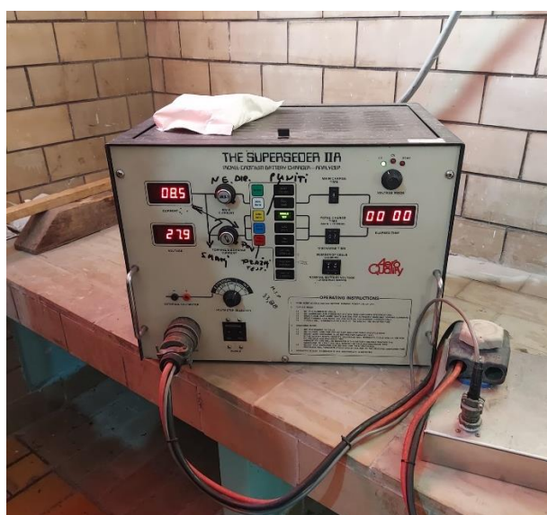
Slika 13. Uređaj za testiranje nikal-kadmijevih akumulatora
