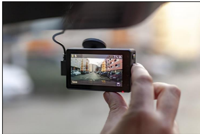
Slika 7. Kamera u vozilu kao sredstvo praćenja dinamike vozila
