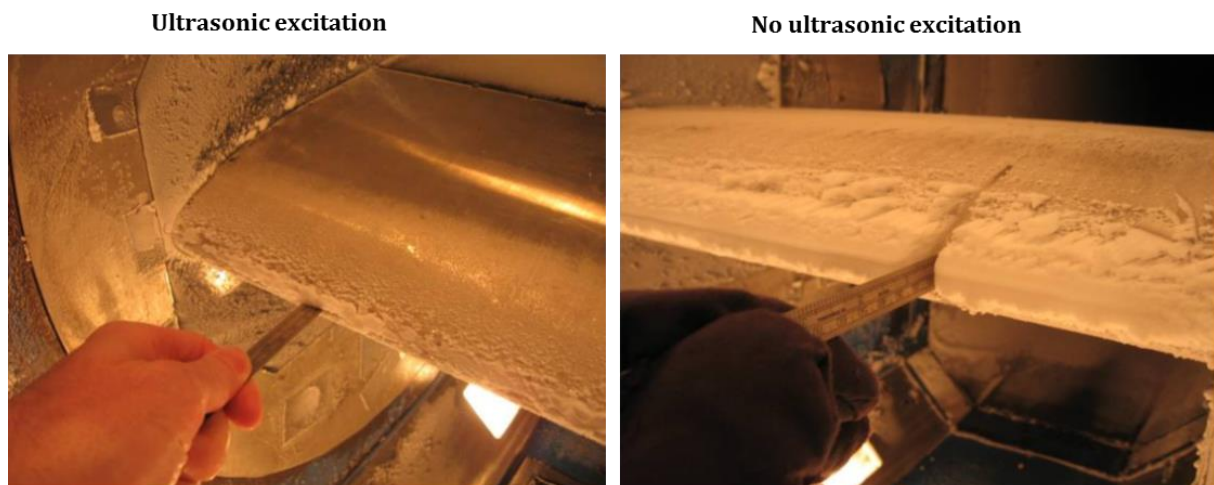
Slika 29. Rezultati provođenja testiranja ultrazvučne tehnologije u zračnim tunelima Izvor: [35]
