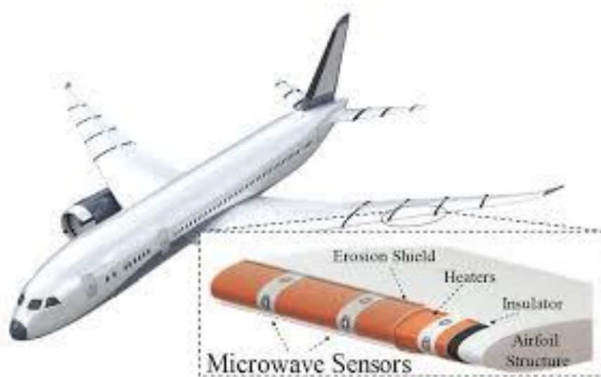
Slika 26. Hibridni sustav na zrakoplovu koji koristi kombinaciju grijača i mikrovalnih senzora integriranih ispod zaštitnih slojeva Izvor: [30]
