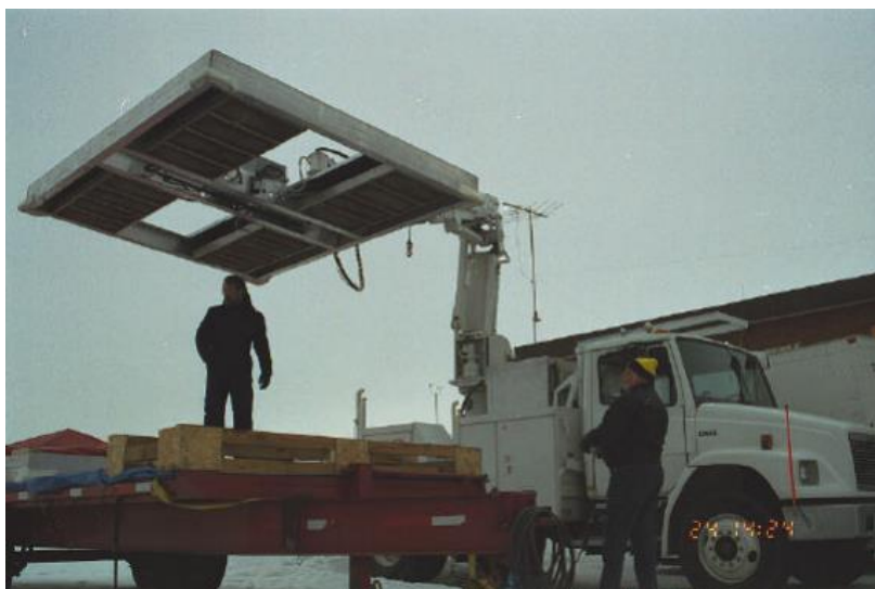
Slika 20. Mobilni infracrveni sustav - ICE CAT Izvor: [23]
