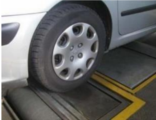
Slika 73. Ispitivanje stupnja prigušenja amortizera
