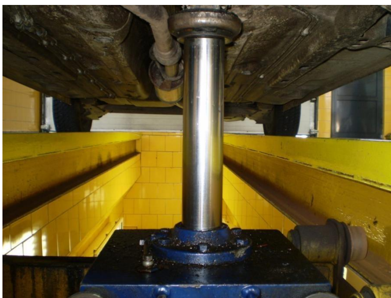
Slika 70. Dizalica za tehnički pregled vozila
