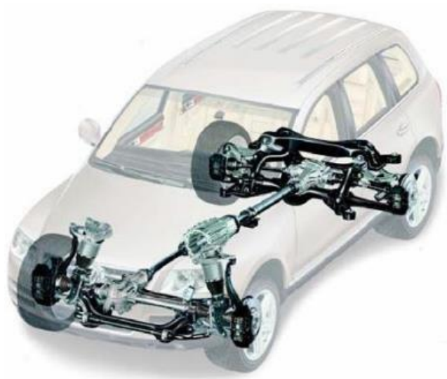
Slika 46. Podvozje s dijelom prijenosnika snage
