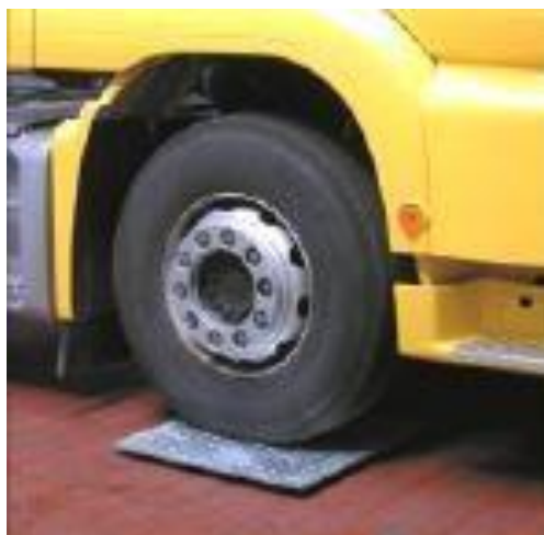
Slika 69. Razvlačilica za tehnički pregled vozila
