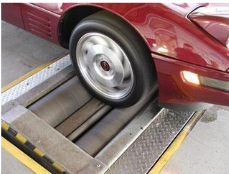
Slika 74. Valjci za ispitivanje sile kočenja
