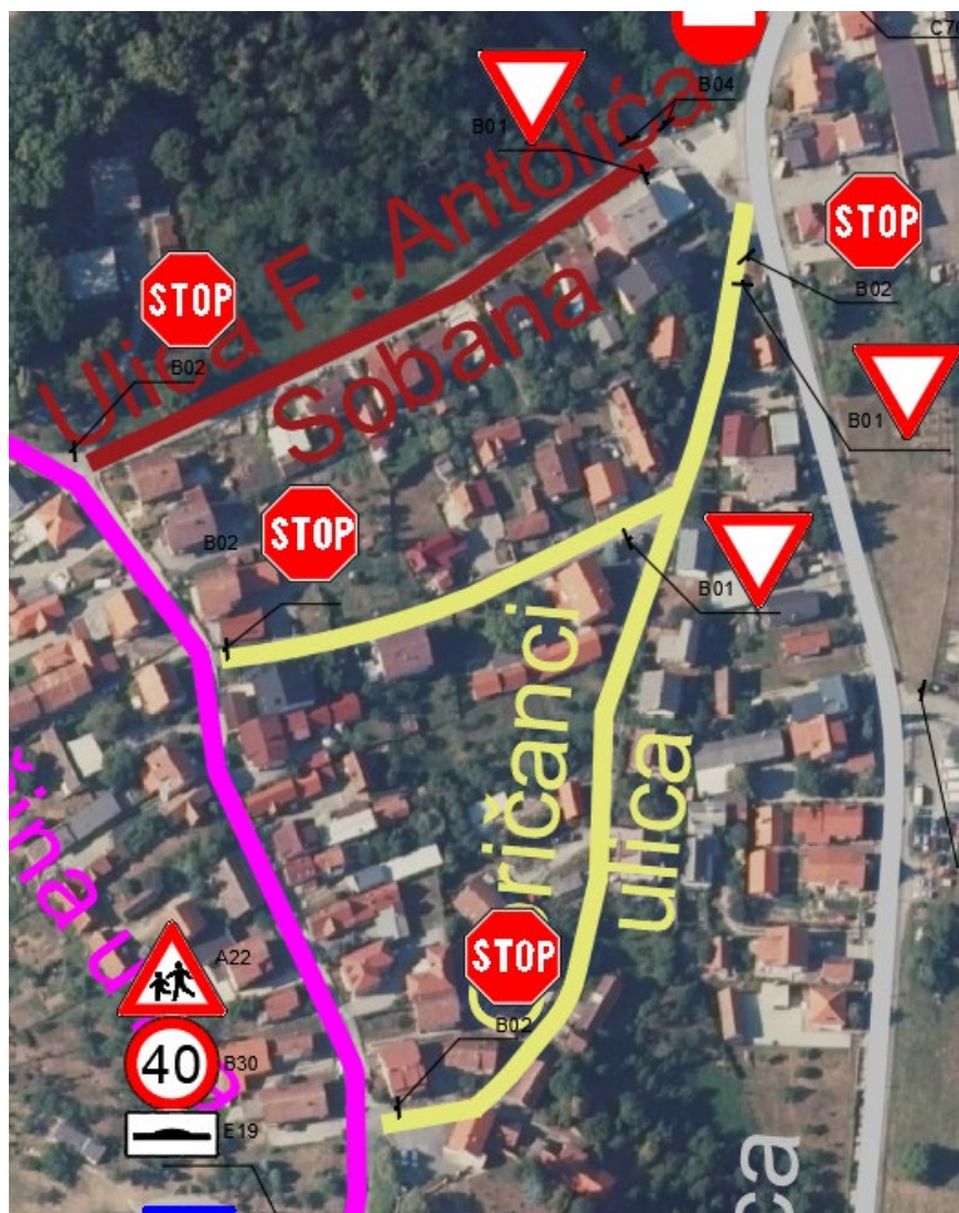
Slika 50. . Postavljeni prometni znakovi u Ulici Filipa Antolića sobana i Goričanci ulica
