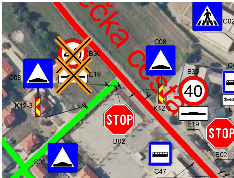
Slika 77. Prometni znakovi koje je potrebno ukloniti
