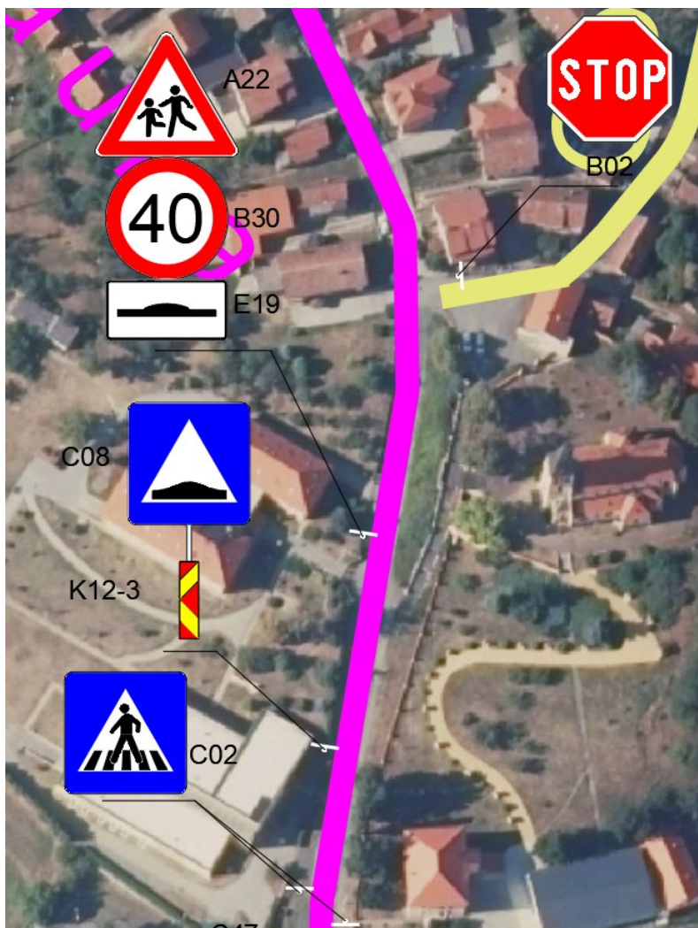
Slika 49. Postavljeni prometni znakovi u Granešina ulica
