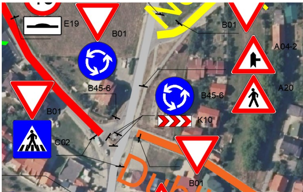
Slika 40. Postavljeni prometni znakovi na kružnom toku
