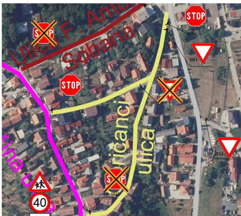
Slika 78. Prometni znakovi koje je potrebno ukloniti
