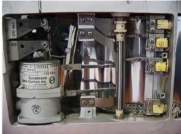
Slika 2. Uređaj za snimanje leta prve generacije Izvor: [7]
