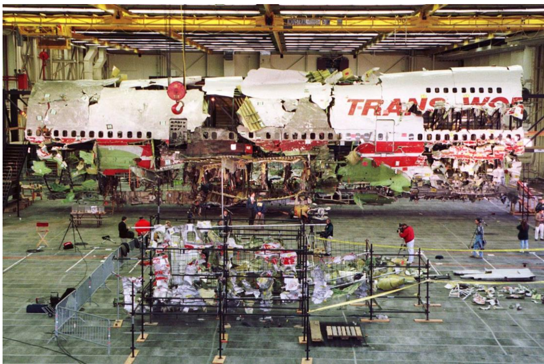
Slika 5. Ostaci zrakoplova Boeing 747 nakon eksplozije Izvor: [10]
