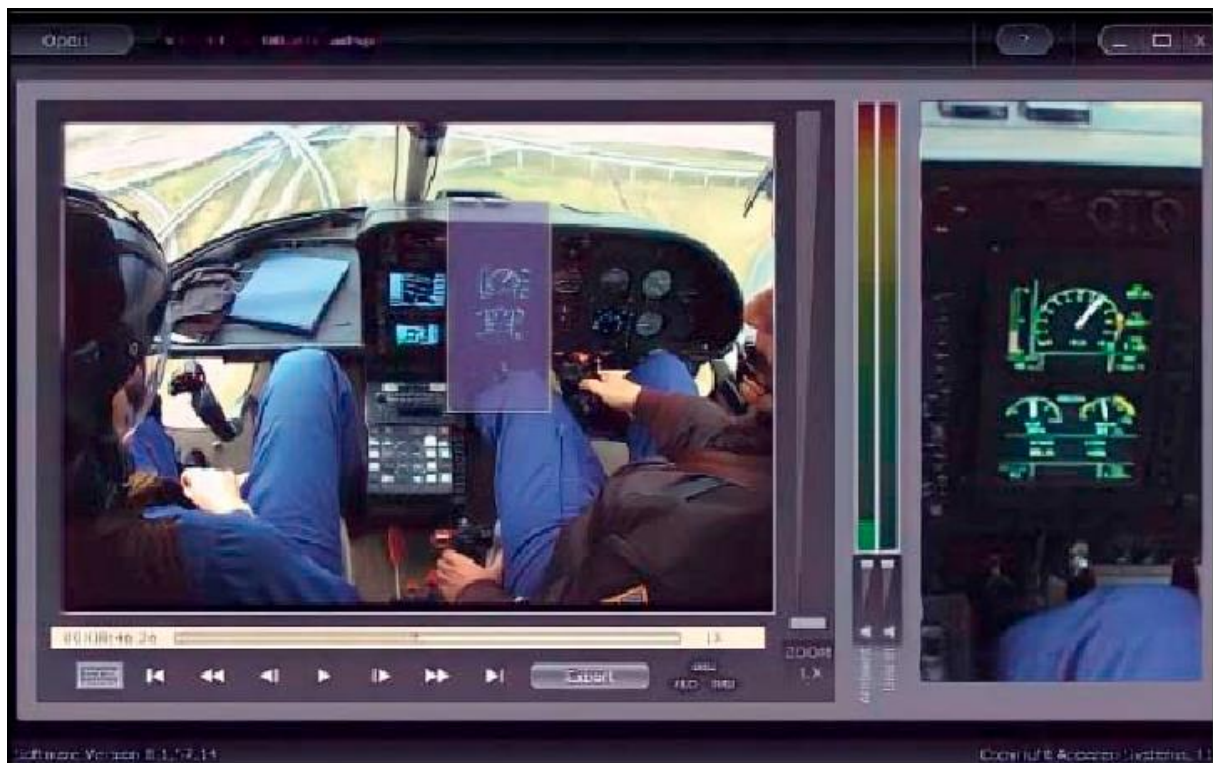
Slika 19. Snimač slike kokpita Izvor: [30]
