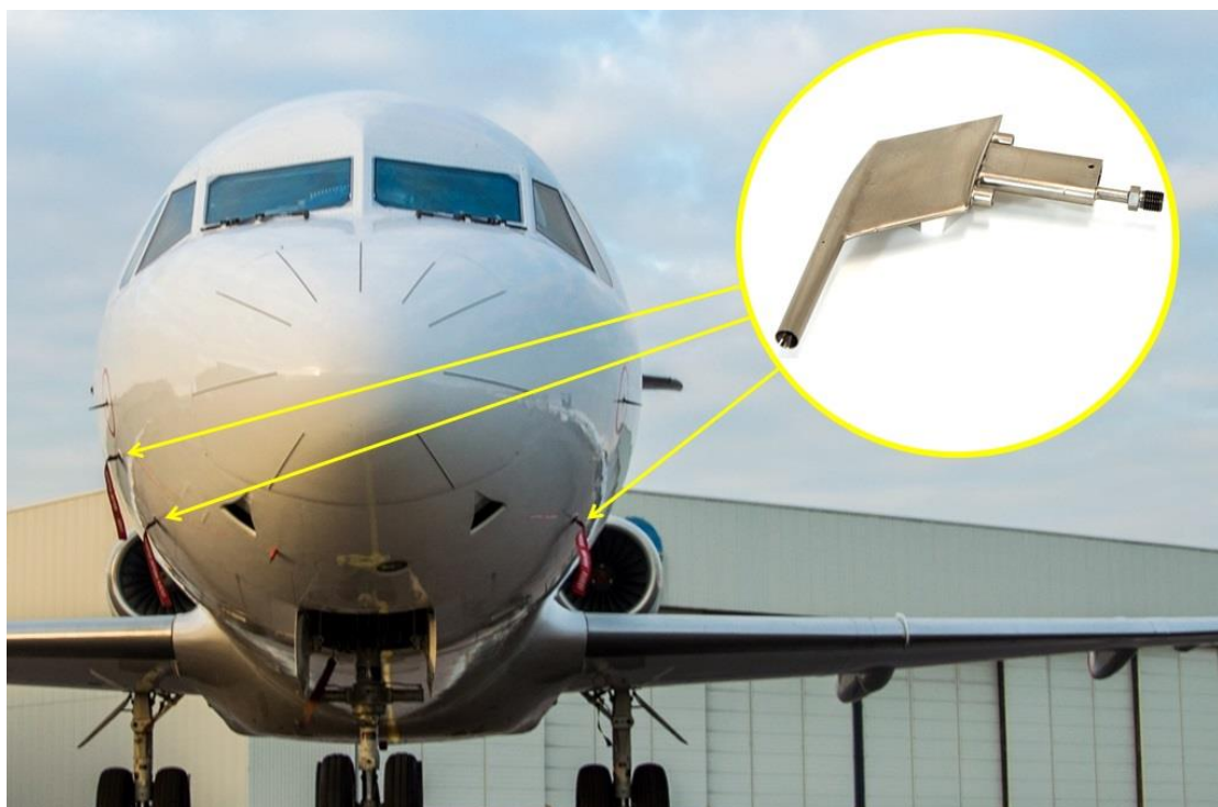
Slika 15. Položaj pitot-cijevi u zrakoplovu Izvor: [38]
