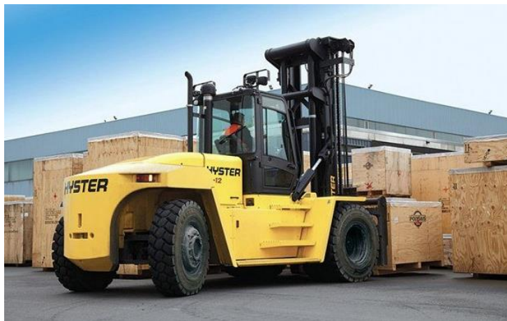
Slika 8 Specijalni čeonu viličar za teške terete
