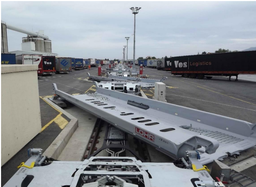
Slika 4 Niskopodni vagon prilikom rotacije za transport poluprikolica, [24]
