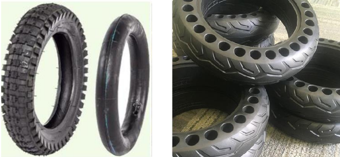
Slika 4 Pneumatske gume (lijevo) i zračne gume (desno)
