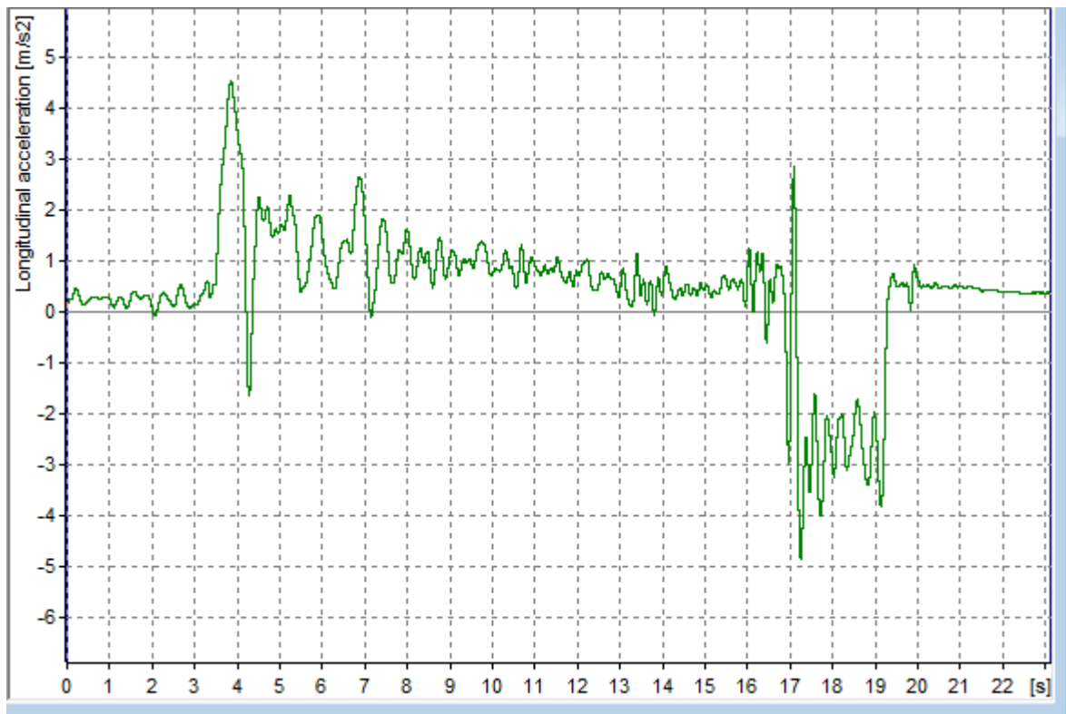
Slika 21 Grafički prikaz 1. mjerenja za MS ENERGY m10 pri brzini od 25 km/h
