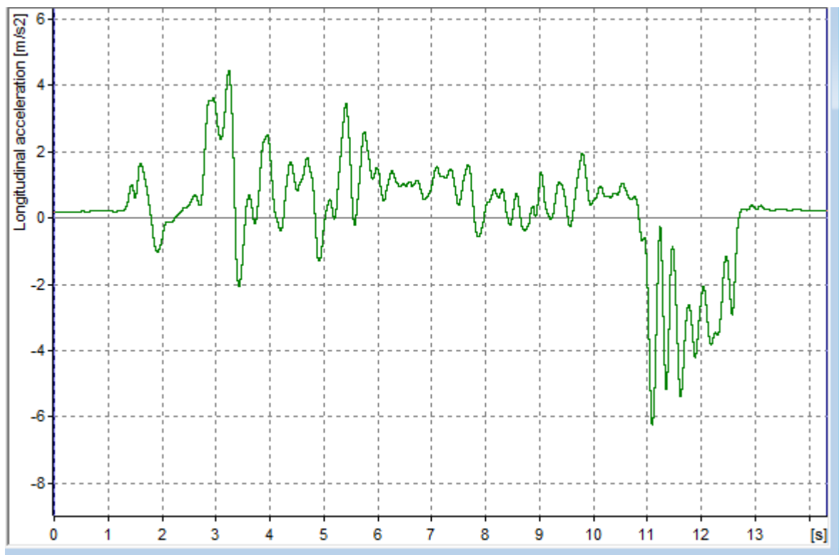
Slika 14 Grafički prikaz 2. testiranja Mi Scooter 365 pri brzini od 15 km/h
