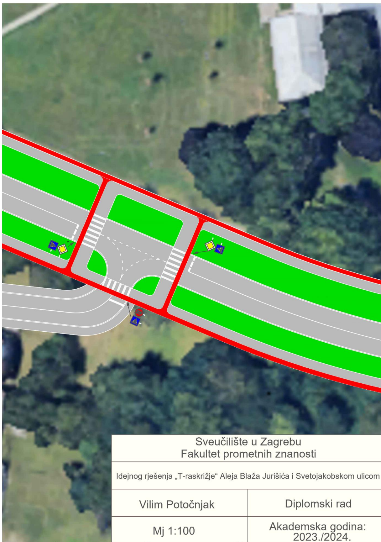
Slika 35. Prikaz idejnog rješenja „T-raskrižje“ Aleja Blaža Jurišića i Svetojakobskom ulicom u programskom alatu AutoCad.
