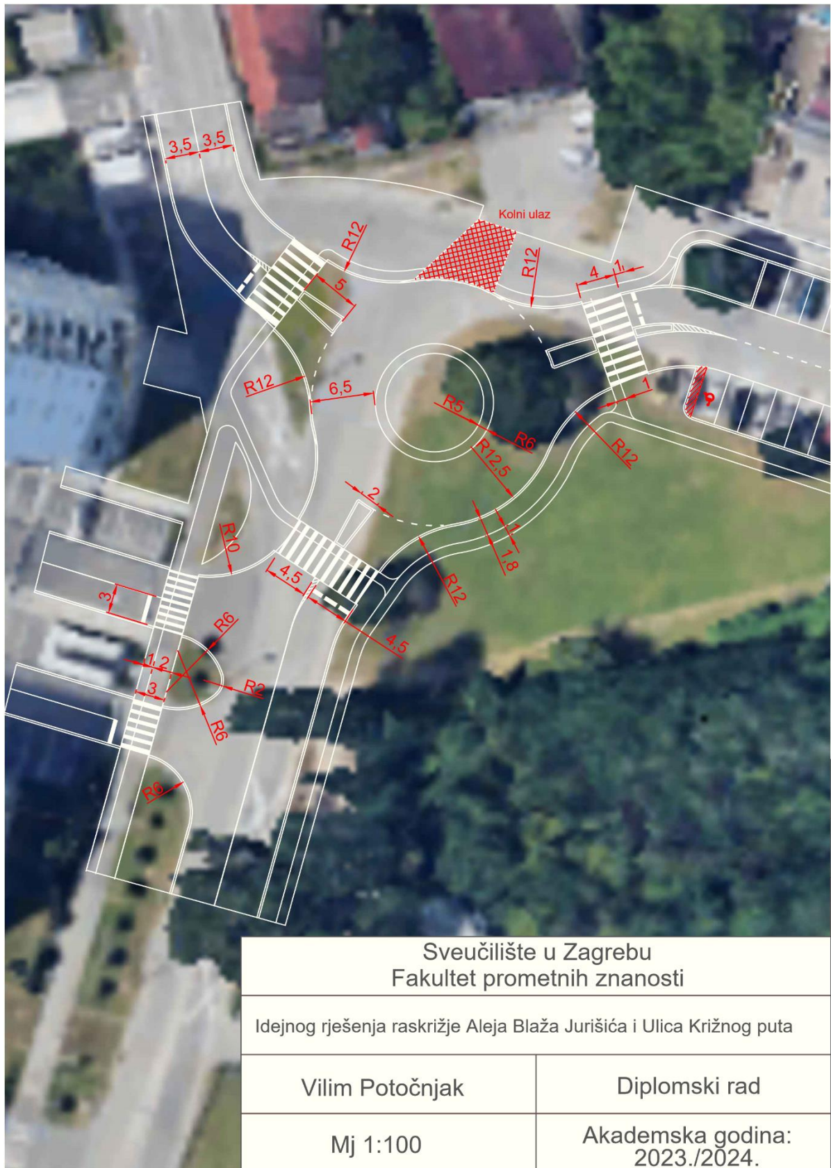
Slika 29. Prikaz s kotama idejnoga rješenja raskrižje Aleja Blaža Jurišića i Ulica Križnog puta u programskom alatu AutoCad.
