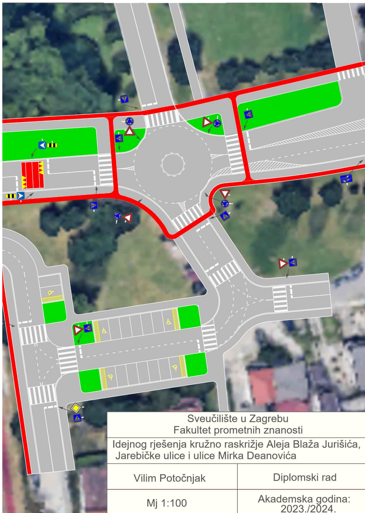
Slika 47. Prikaz idejnog rješenja kružno raskrižje Aleja Blaža Jurišića, Jarebičke ulice i ulice Mirka Deanovića u programskom alatu AutoCad.
