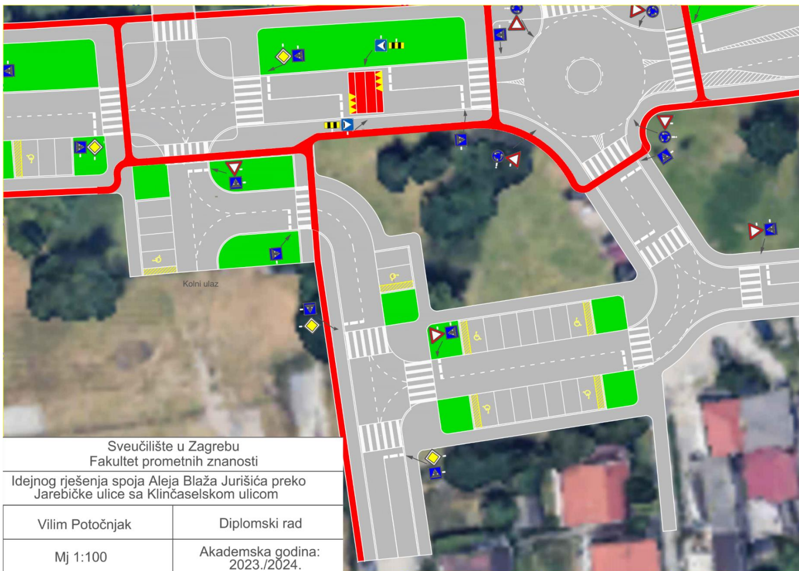
Slika 49. Prikaz idejnog idejnog rješenja spoja Aleja Blaža Jurišića preko Jarebičke ulice sa Klinčaselskom ulicom u programskom alatu AutoCad, izvor: Izradio Autor,
