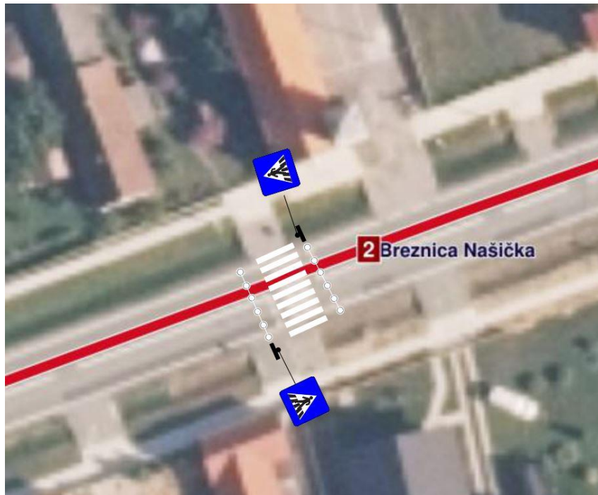
Slika 59. Prijedlog rješenja ugradnje LED markera ispred crkve sv. Martina u Breznici Našičkoj
