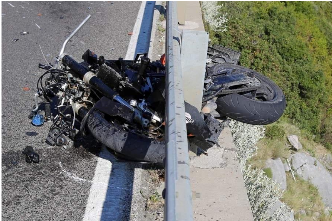
Slika 33. Primjer motocikla koji je podletio pod čeličnu zaštitnu odbojnu ogradu Izvor:[26]
