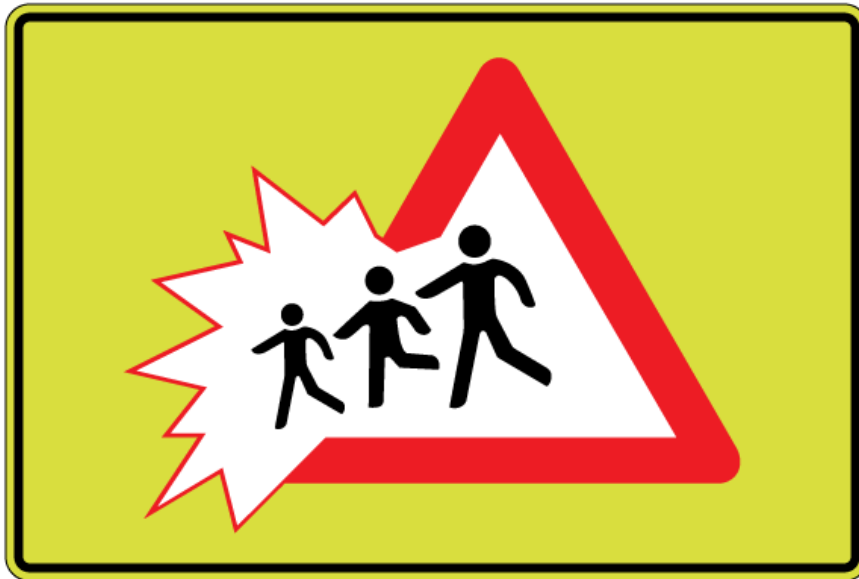
Slika 31. Primjer prometnog znaka s fluorescentnom podlogom RA3 (PZ A22-2) Izvor:[3]
