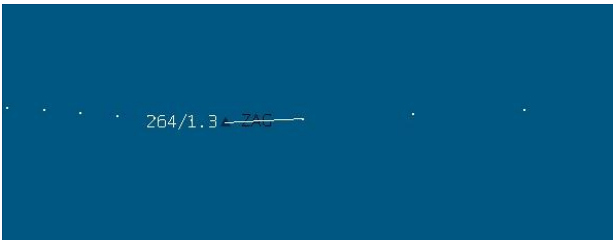
Slika 29: Precizno mjerenje udaljenosti od radarskog otkučaja do navigacijske točke
