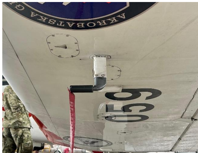
Slika 4. Pitot cijev na Pilatusu PC- 9M
