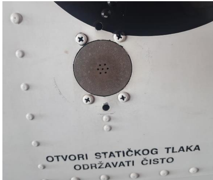
Slika 3. Statički otvor na Pilatusu PC- 9M
