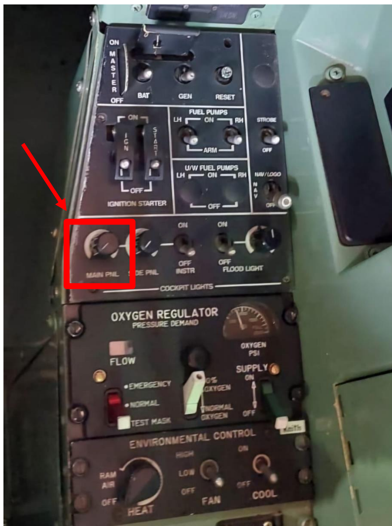
Slika 6. Sklopka MAIN PNL
