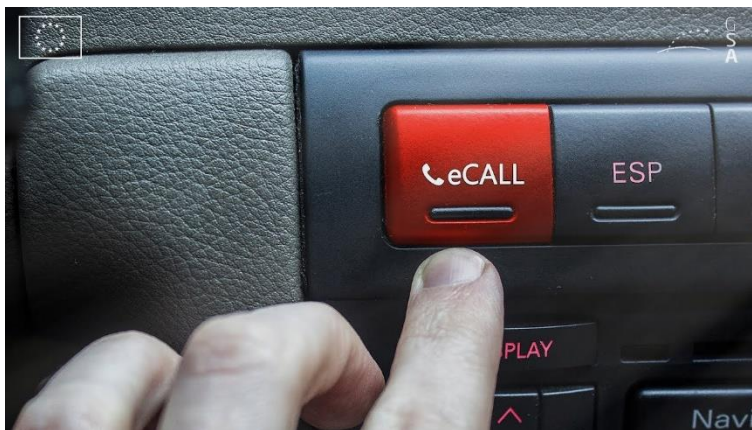
Slika 10. Primjer smještaja tipke za ručnu aktivaciju ePoziva, [17]
