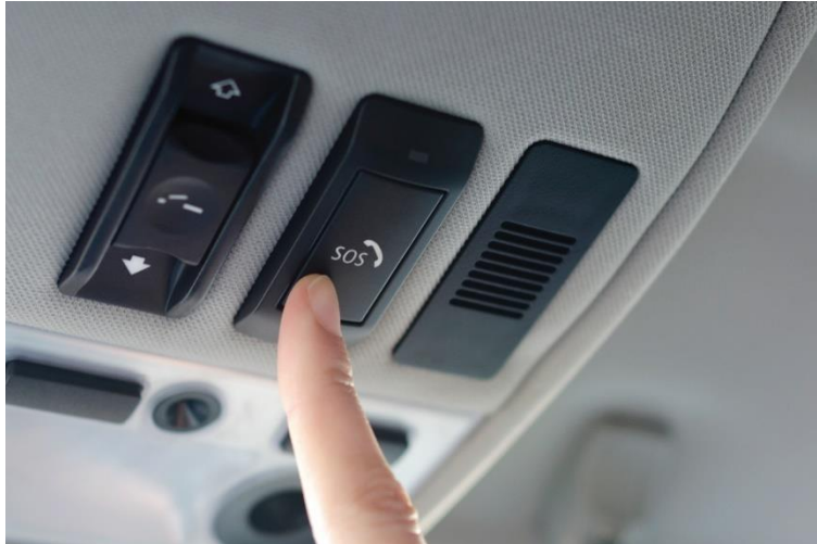
Slika 9. Primjer smještaja tipke za ručnu aktivaciju ePoziva, [16]:
