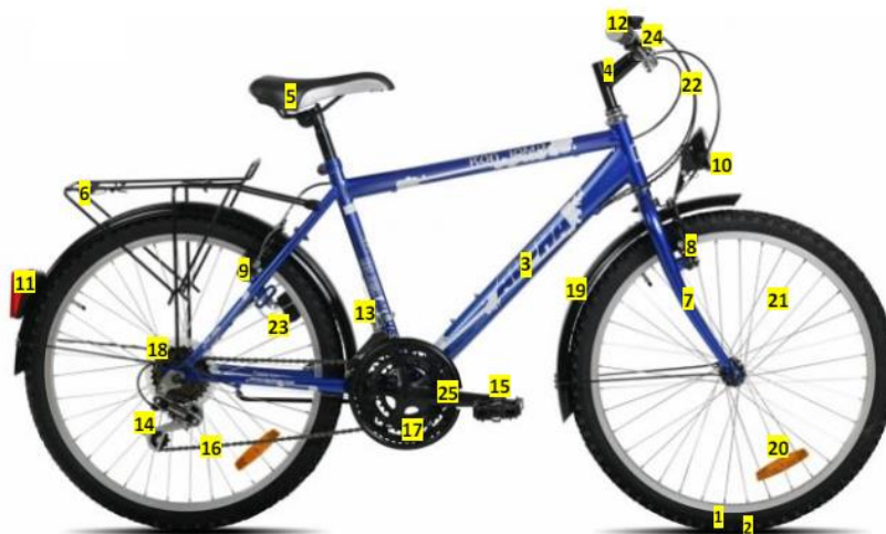
Slika 3.1. Osnovni dijelovi bicikla
