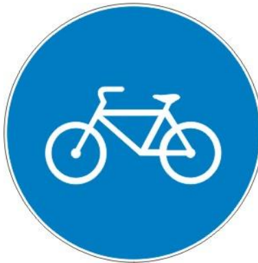
Slika 23. B40 - Biciklistička traka ili staza
