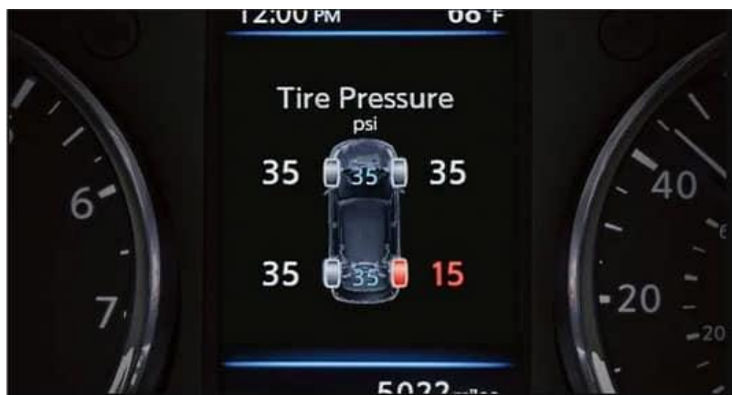
Slika 14 Sustav praćenja tlaka u gumama [24]
