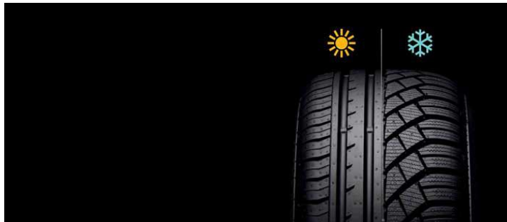
Slika 8. Gazni sloj ljetne i zimske gume [15]
