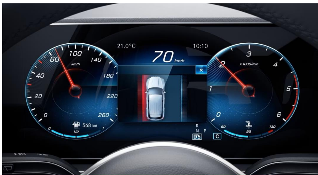
Slika 15. Sustav praćenja za napuštanje prometnog traka [25]
