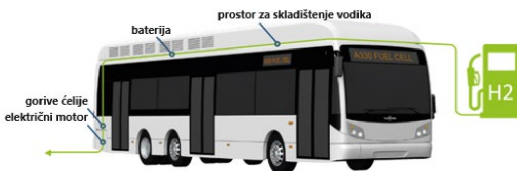
Slika 15. Elementi autobusa na gorive ćelije
