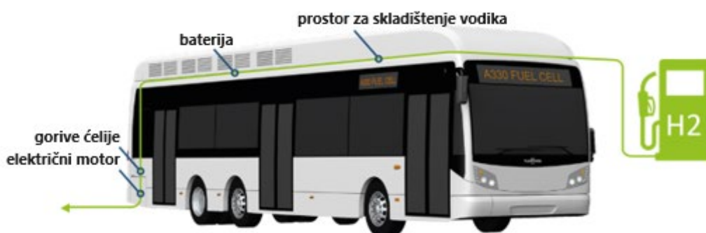
Slika 15. Elementi autobusa na gorive ćelije
